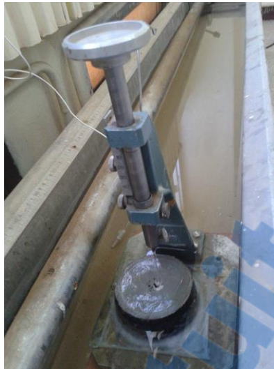
Figure 3. 9. Appareil de Vicat dans le bain Marie (Photo prise par les auteurs)
