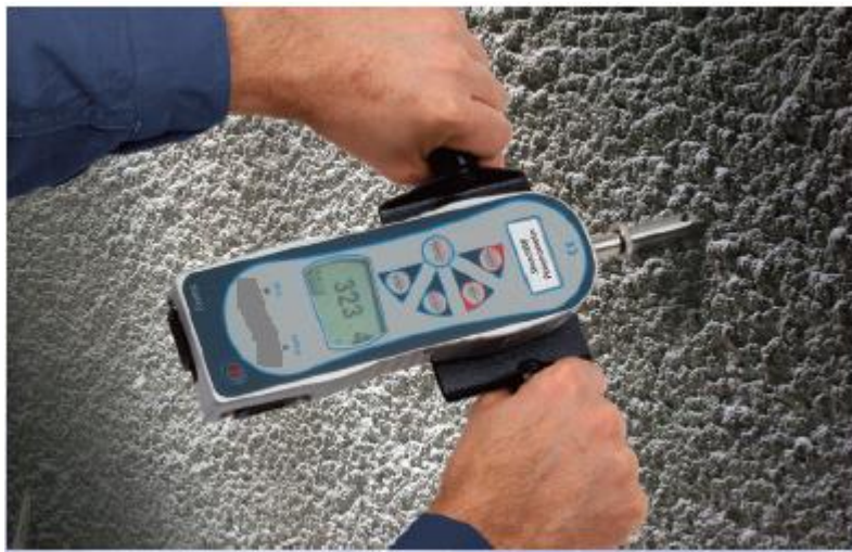
Figure 2. 16. Appareil de pénétration (méthode A) (Shotcrete Penetrometer, 2014)
