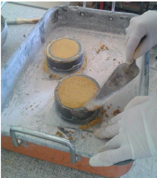
Figure 3. 8. Lissage de la surface et saupoudrage du démoulant (Photos prises par les auteurs)
