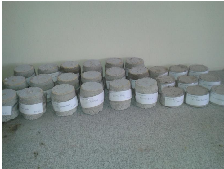
Figure 3. 11. Echantillons de MT réalisés avec un rapport E/C = 0,7 (Photo prise par les auteurs)
