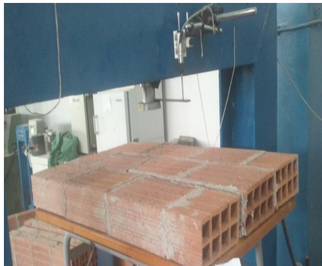
Figure 3.22 : Essai de flexion du muret-test (photos prise par les auteurs)
