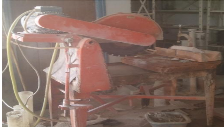
Figure 3.13 Scie à Béton (photo prise par les auteurs)
