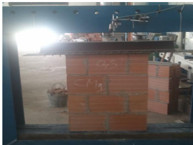
Figure 3.24 : Muret sous charge de compression (photos prise par les auteurs)
