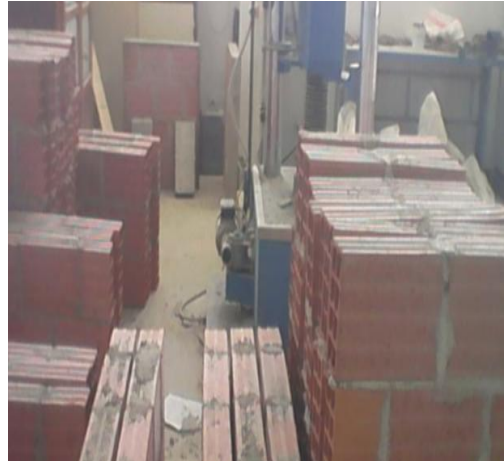
Figure 3.20 Cure et stockage des murs (photos prise par les auteurs)
