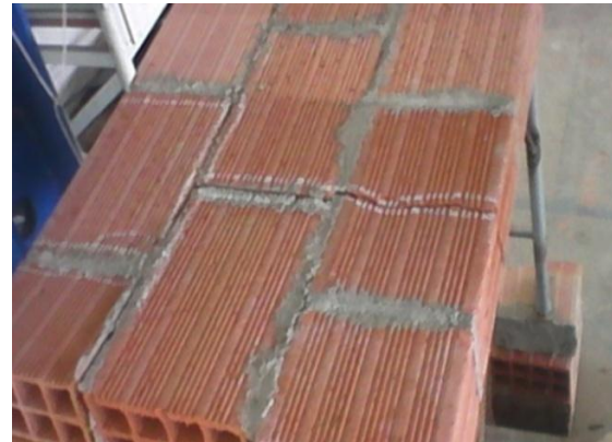
(b) : Ligne de fissure de forme denté.
