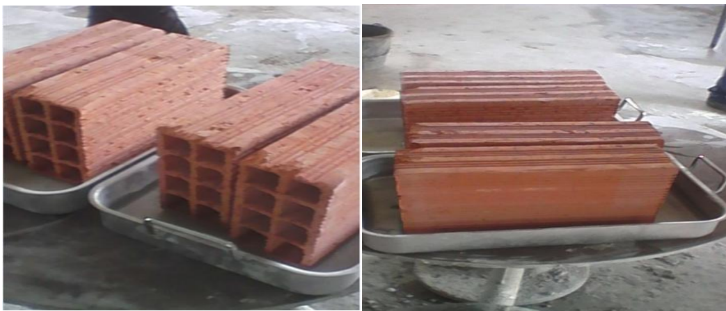
Figure 3.1 : Essai de l'absorption des briques (Photos prises par les auteurs)
