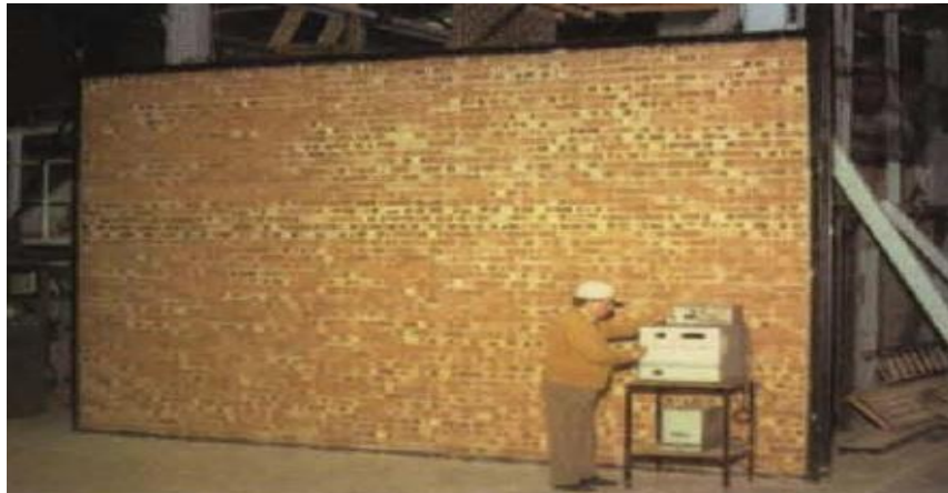
Figure.2.12 : Panneaux muraux à pleine échelle construits dans des bancs d'essai (MORTON, 1986)
