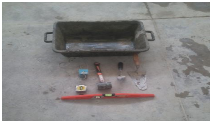
Figure 3.12 : Outils utilisés pour l'auto-construction par les étudiants (photo prise par les auteurs)
