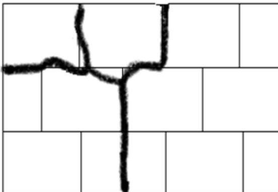
(b) : Ligne de fissure de forme denté.
