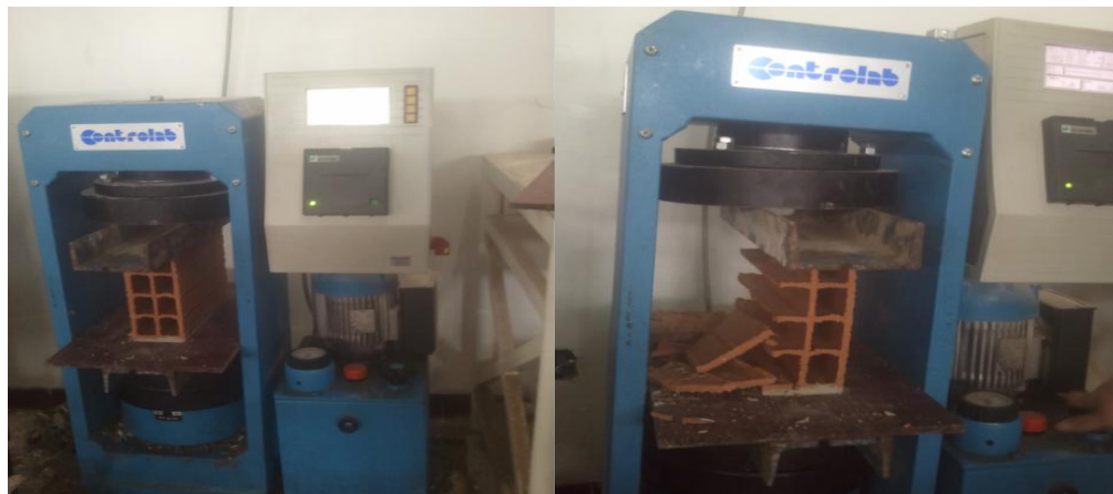
Figure 3.2: Presse universelle (photos prises par les auteurs).
