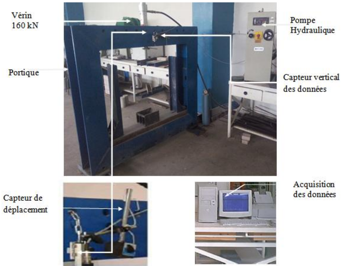
Figure 3.21 : L'ensemble du dispositif d'essai (photos prise par les auteurs)
