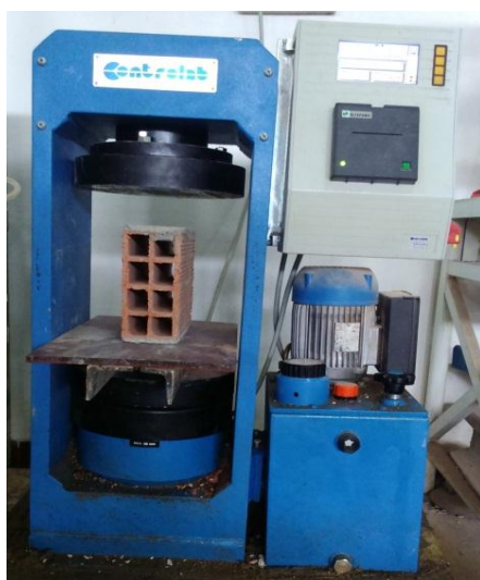
Figure 3.7 : Écrasement de la brique à l'aide de la presse universelle (photo prise par les auteurs).
