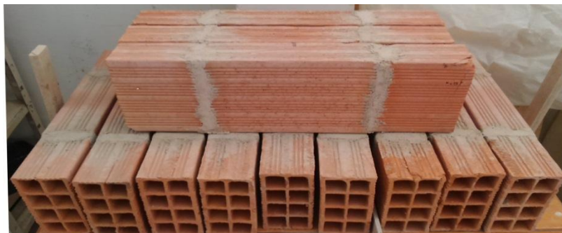
Figure 3.45 : Cure et stockage des triplets finis et prêts à l'écrasement (photo prise par les auteurs).
