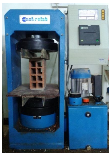
Figure 3.7 : Écrasement de la brique à l'aide de la presse universelle (photo prise par les auteurs).
