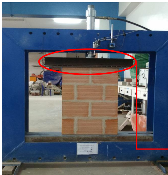
Figure 3.43 : Banc didactique pour l'essai de compression.
