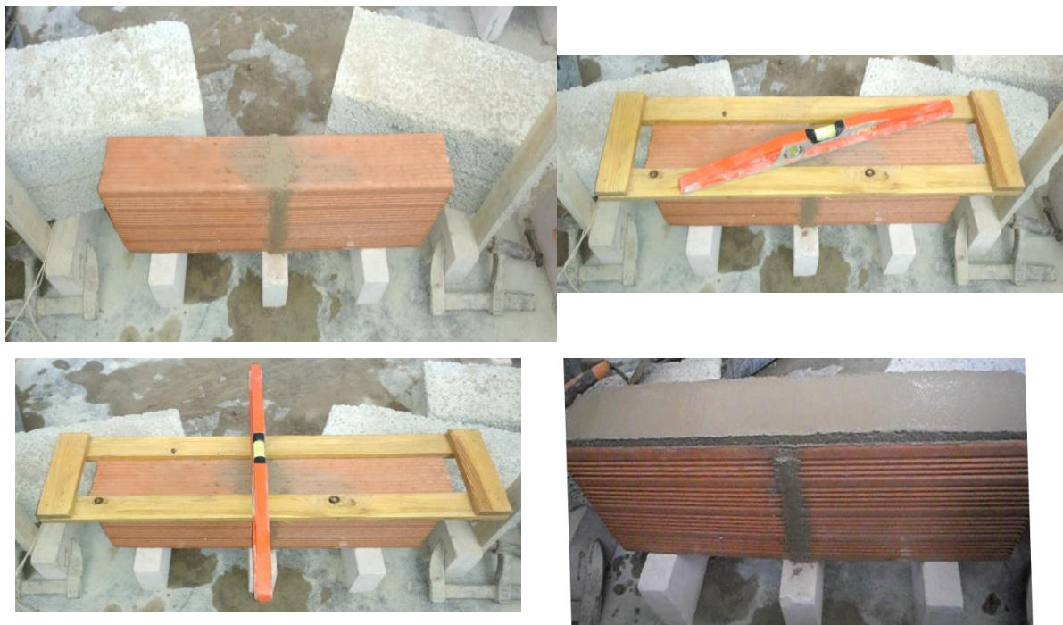
Figure 3.31 : Remplissage des joints verticaux ensuite l'étalement de la première couche du mortier.
