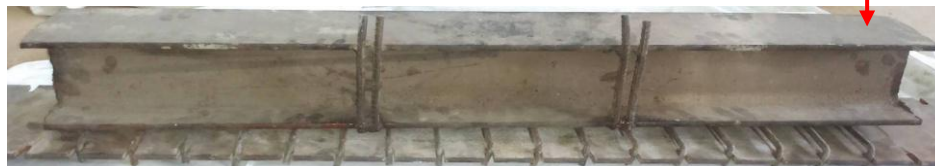
Figure 3.44 : Barres de transmission des charges (photos prises par les auteurs).
