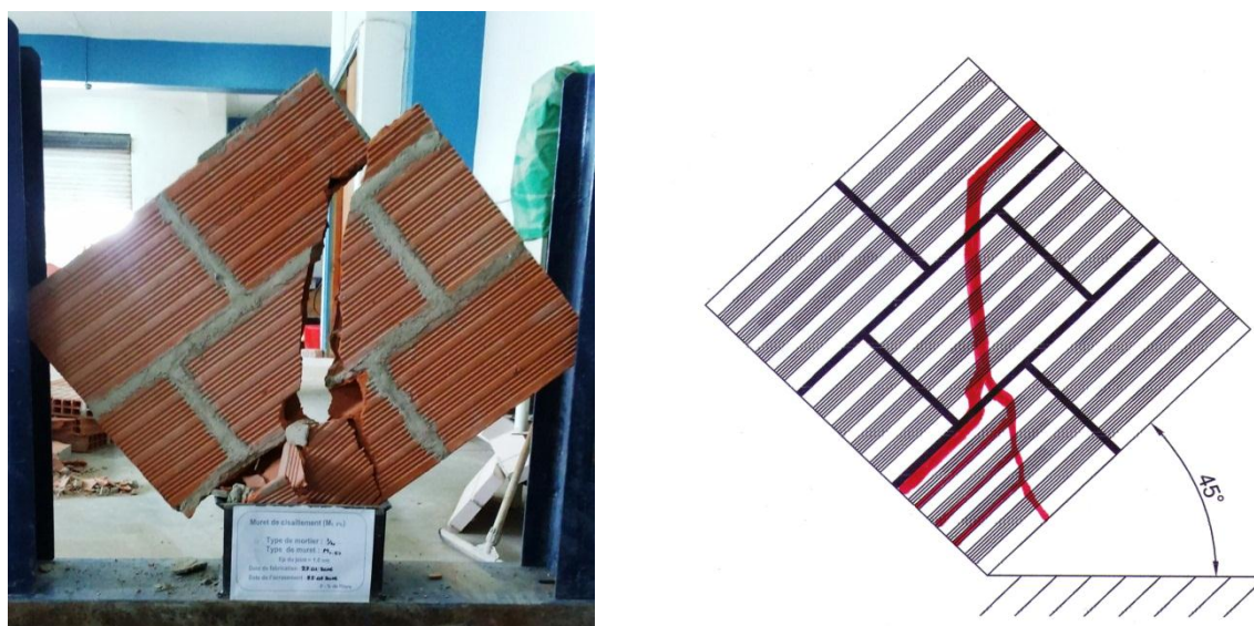
Figure 4.2 : Rupture en coup de sabre.
