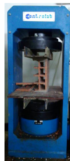
Figure 3.7 : Écrasement de la brique à l'aide de la presse universelle (photo prise par les auteurs).
