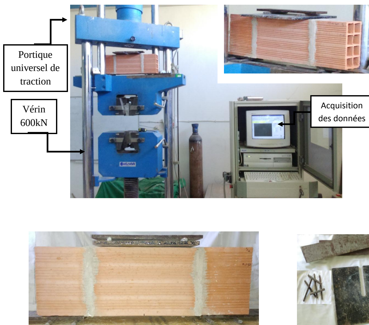
Figure 3.46 : L'essai de résistance au cisaillement à l'aide de la machine universelle de traction (photo prise par les auteurs).
