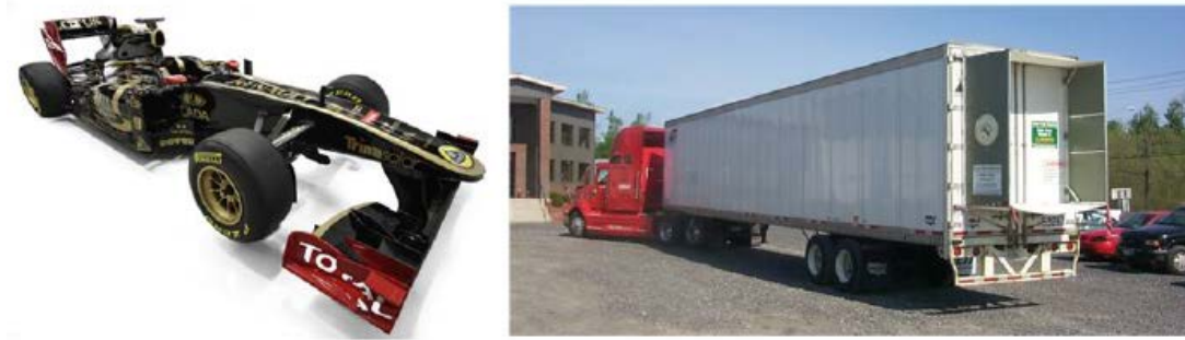
Figure 1.16 : Appendices aérodynamiques : Lotus Renault R31 2011 (gauche) et plaques séparatrices longitudinales sur un poids lourd (droite) [2]
