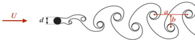
Figure II. 2 - Visualisation schématique des allées de Bénard-Karman[9]
