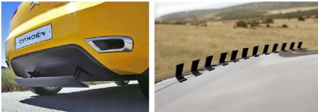
Figure I.22 : Contrôle actif chez PSA : aileron déployable sur C-Sportlounge (gauche) et générateurs de vortex escamotable sur C-Airlounge (droite)[2]
