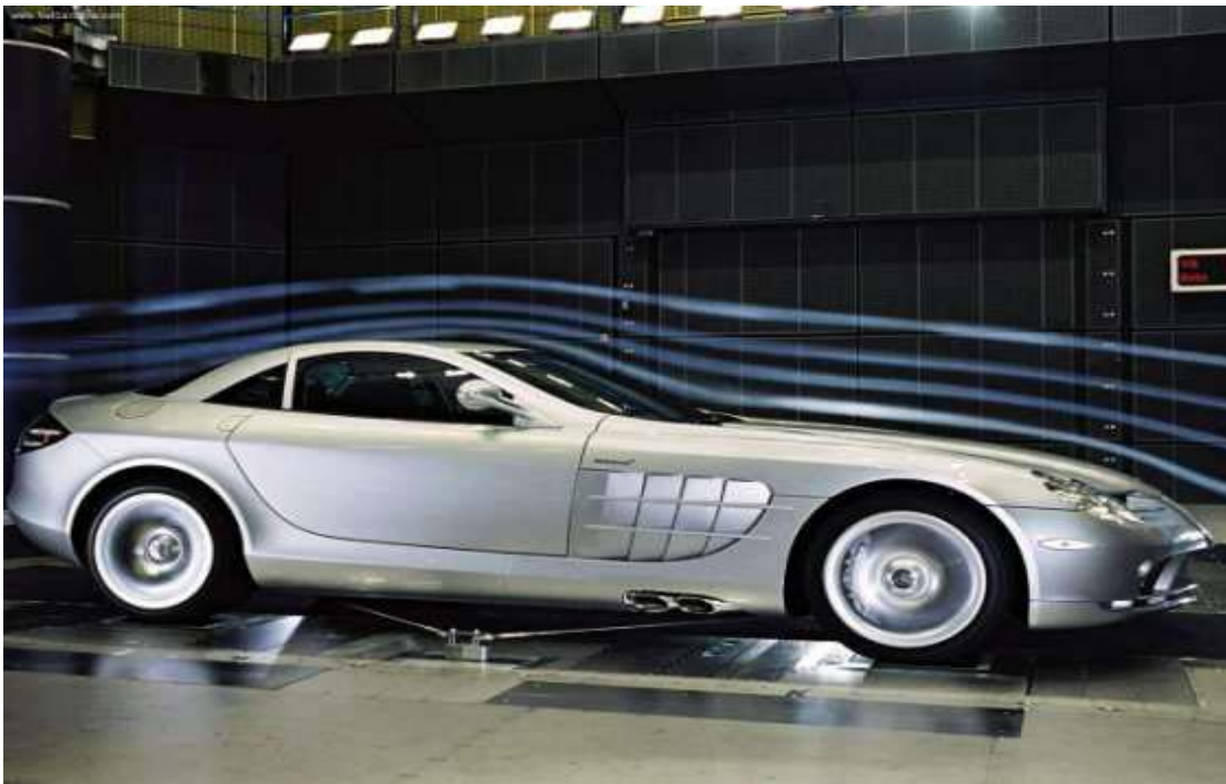
Figure I.6 : Ecoulement d'air autour d'une Mercedes SLR McLaren (photo constructeur)[2]
