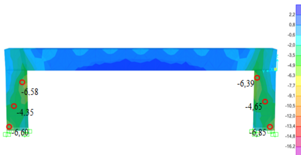
Figure 3.14 : Contraintes au niveau des poteaux principaux
