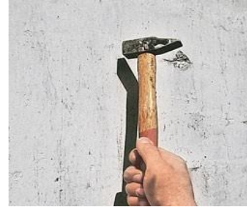
Figure 4.16: Sondage au marteau
