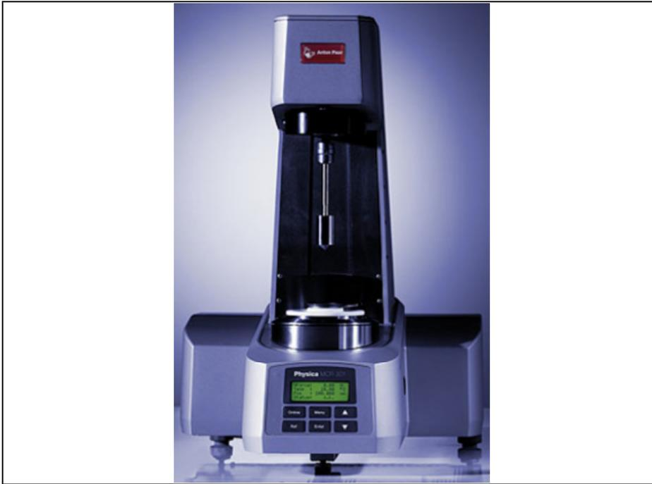
Figure 2.2 Rhéomètre MCR 301 avec géométrie cylindres coaxiaux
