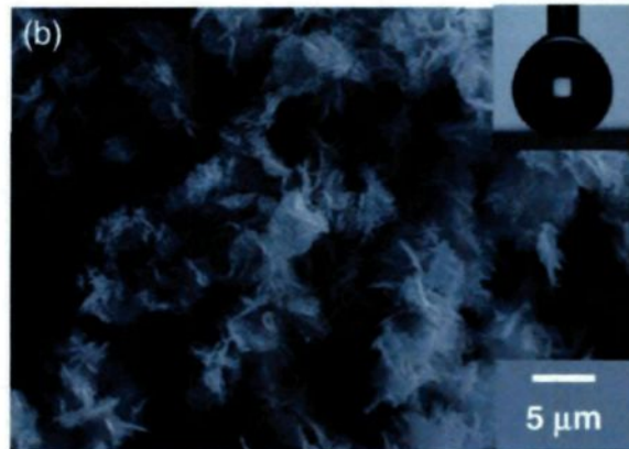
Figure 6 : Film d'argent sur du cuivre [17]. La couche mince est obtenue par l'immersion d'un substrat de cuivre dans une solution de nitrate d'argent et d'acide benzoïque. Dans le coin droit, une goutte d'eau sur la surface montre un angle de 162^\circ .
