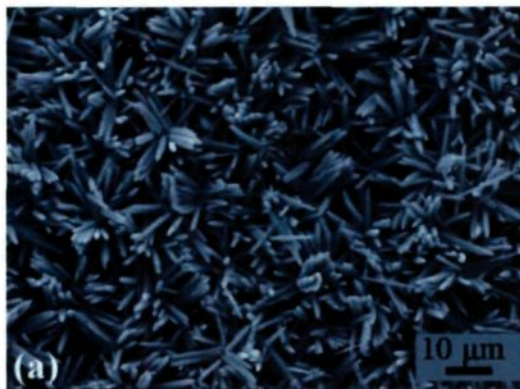
Figure 5 : Nano tours de ZnO sur silicium [22]. Les nano tours sont obtenue par bain chimique sur un substrat d'aluminium en utilisant du nitrate de zinc et de l'hydroxyde d'ammoniac.
