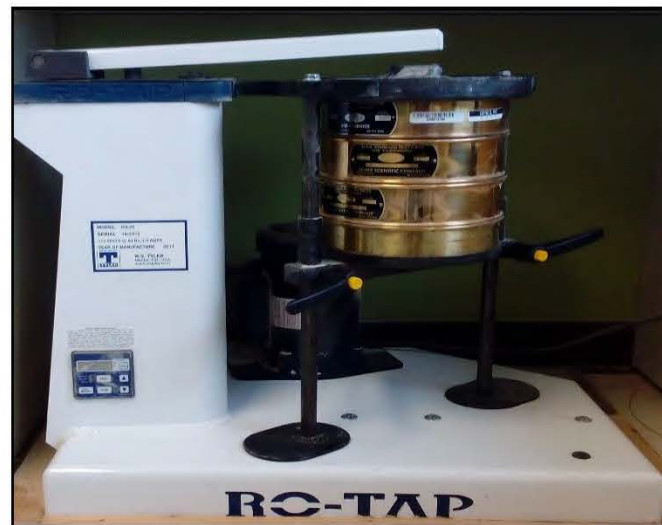
Figure 2.5 : Appareil de tamisage comportant une série de tamis (Ro-Tap RX29, W.S Tyler)
