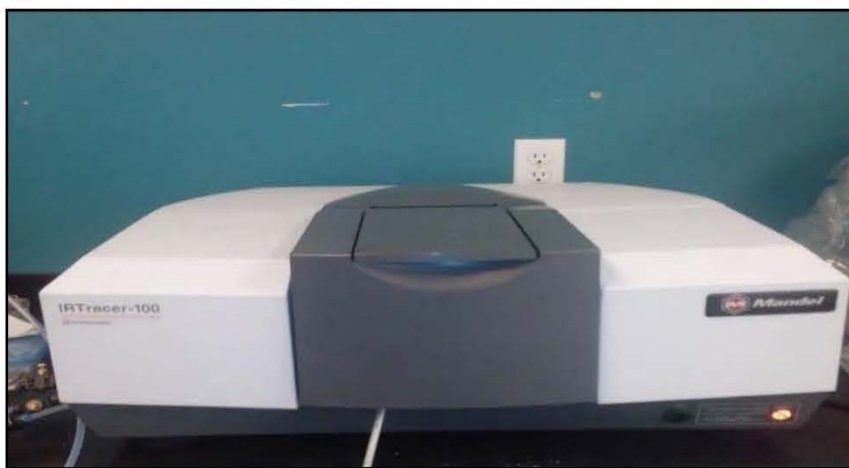
Figure 2.10 : Appareil de spectroscopie infrarouge à transformée de Fourier de l'UQAT (Shimadzu IR Tracer-100, kyoto, Japon)
