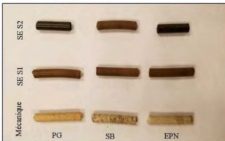
Figure 3.18 : Granules de fibres brutes et explosées à deux sévérités différentes
