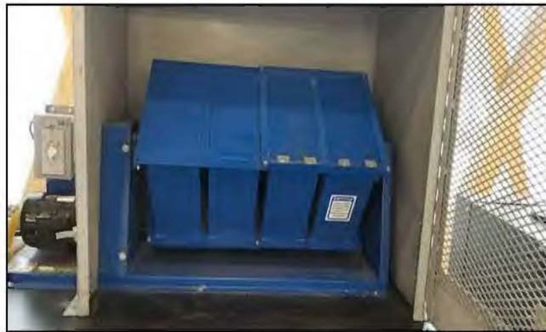
Figure 2.12 : Durabilimètre composé de quatre boîtiers
