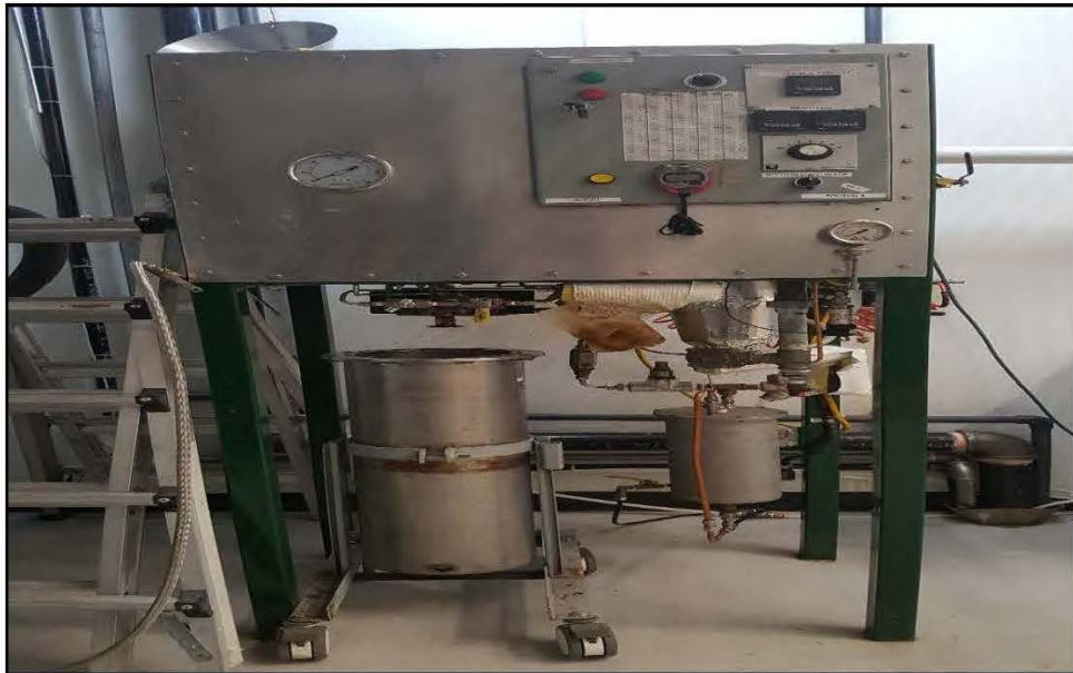
Figure 2.4 : Aperçu de l'unité d'explosion à la vapeur du laboratoire de l'Université de Sherbrooke
