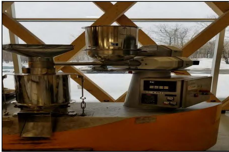
Figure 2.8 : Dispositif de granulation du laboratoire du CTRI (KAHL 14-175)
