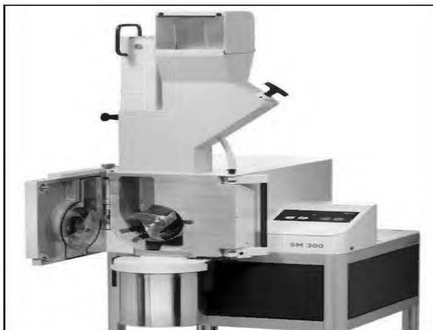
Figure 2.1 : Broyeur à coteaux rotatifs installé à l'UQAT (Retsch, modèle SM 100)
