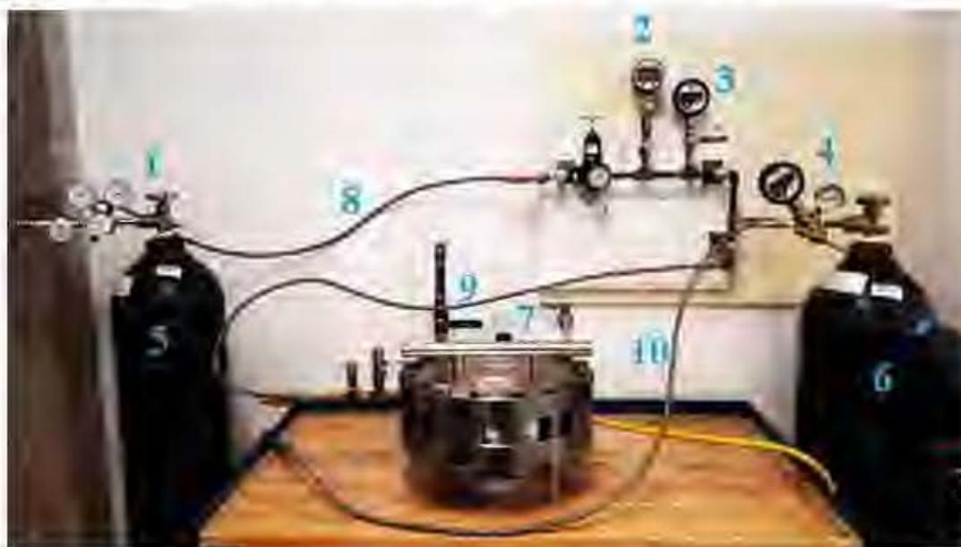
Figure 3-5: Circuit de l'essai en cellule de pression
