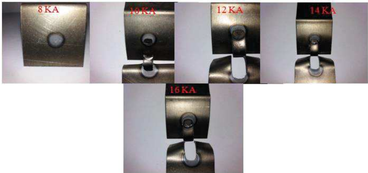
Figure III.15 Les éprouvettes ( e=1\text{mm} ) rompues après l'essai de traction pour T=25 Cycle et F=6 Bars
