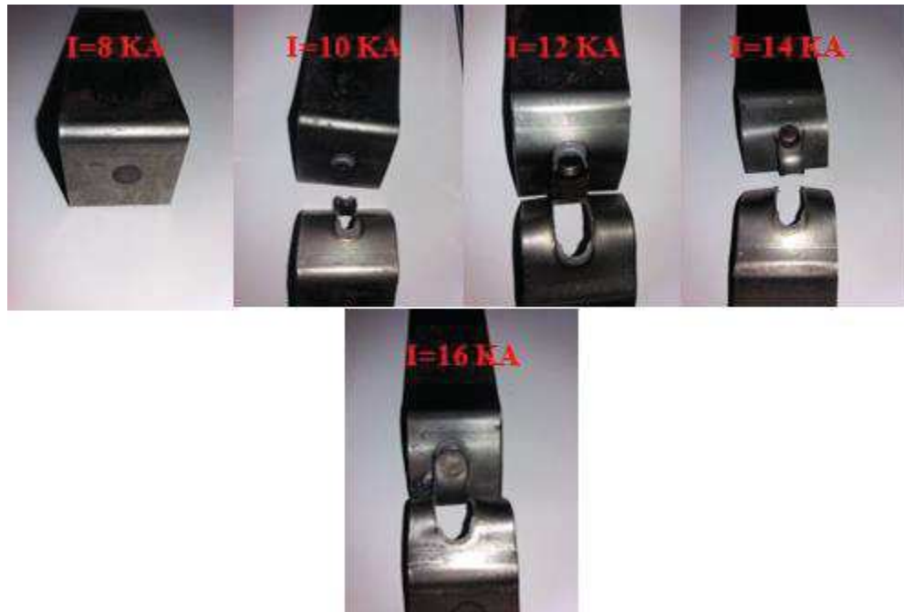
Figure III.2 Les épreuves ( e=2\text{mm} ) rompues après l'essai de traction pour T=18 Cycle et F=6 Bars
