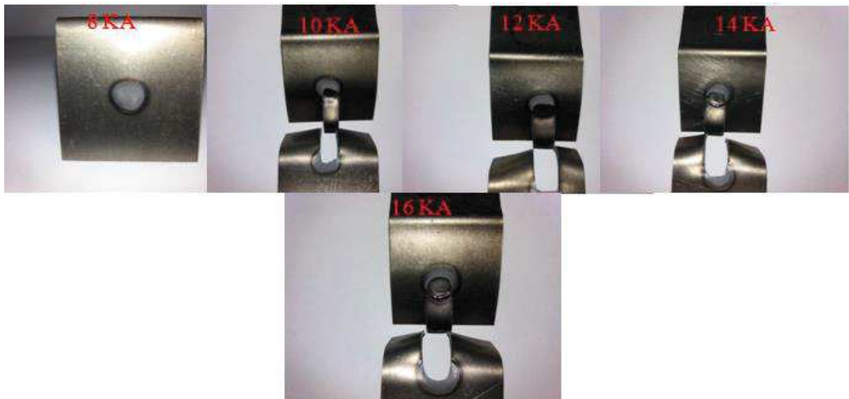
Figure III.13 Les éprouvettes ( e=1\text{mm} ) rompues après l'essai de traction pour T=18 Cycle et F=7 Bars
