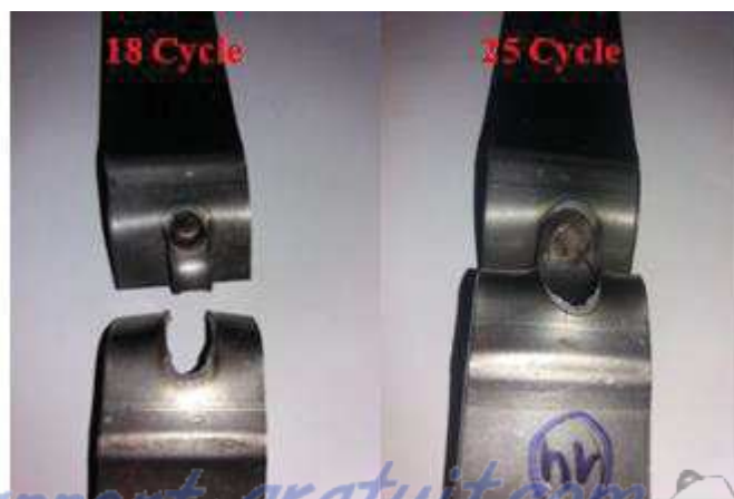
Figure III.29 : Faciès de rupture pour les éprouvettes soudées avec 14 KA
