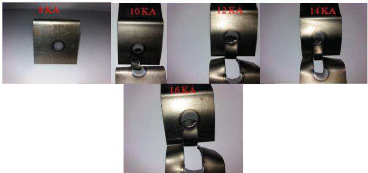
Figure III.17 Les éprouvettes ( e=1\text{ mm} ) rompues après l'essai de traction pour T=25\text{ Cycle} et F=7\text{ Bars}
