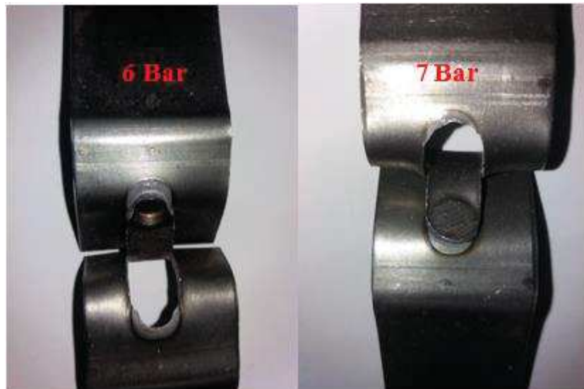
Figure III.18 : Faciès de rupture pour les éprouvettes soudés avec 12 KA
