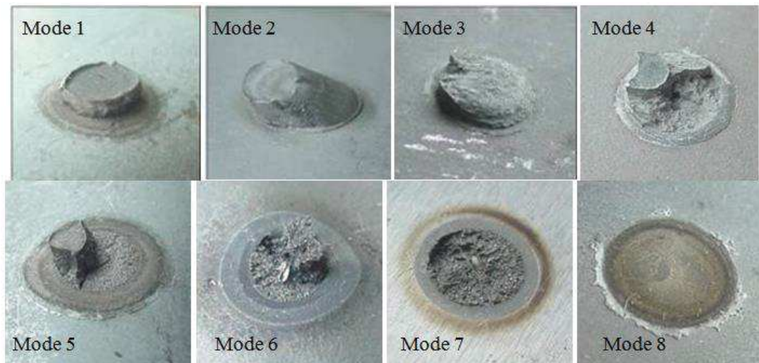
Figure III.1 : Différents modes de ruptures recensés par l'AWS [9]
