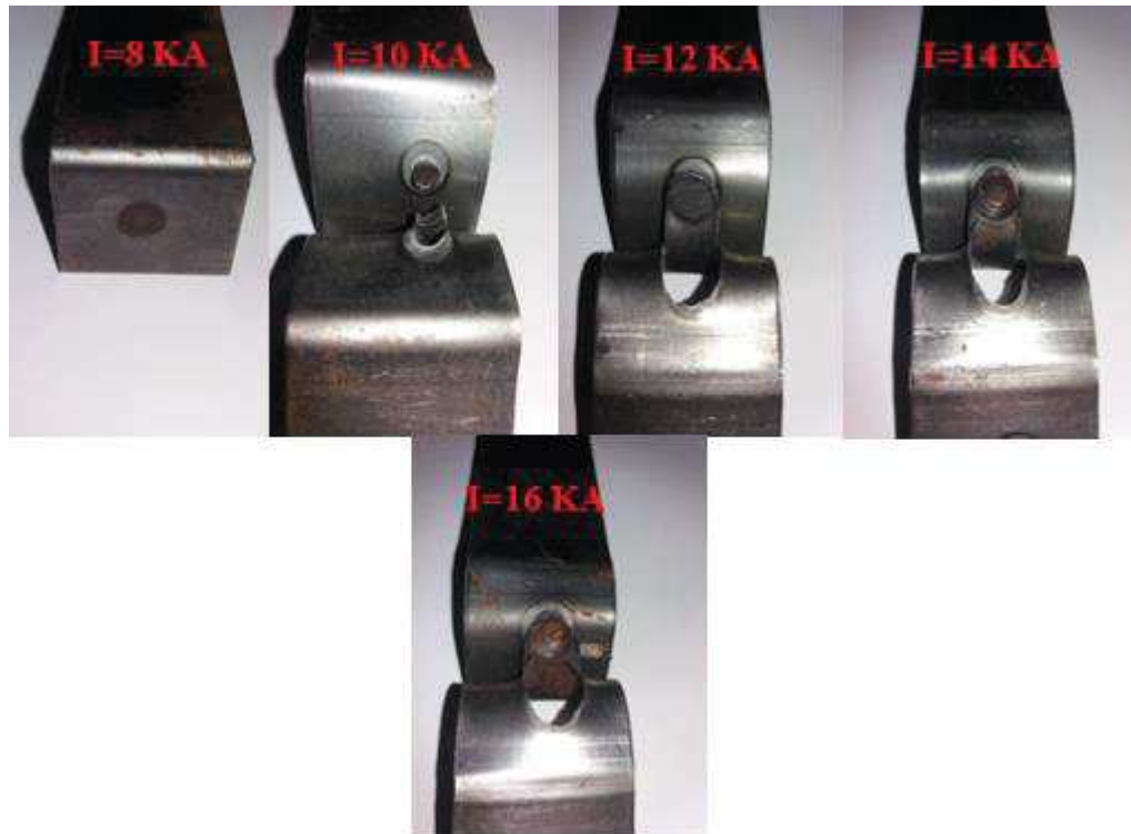
Figure III.4 Les éprouvettes ( e=2\text{mm} ) rompues après l'essai de traction pour T=18 Cycle et F=7 Bars
