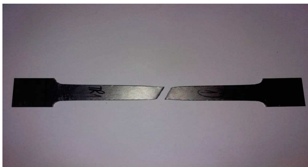
Figure II.16 : Eprouvette normalisée après rupture.
