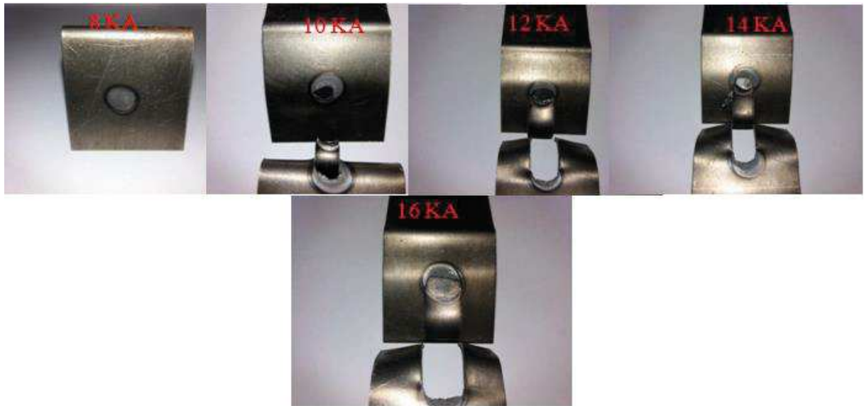
Figure III.11 Les éprouvettes ( e=1\text{mm} ) rompues après l'essai de traction pour T=18 Cycle et F=6 Bars
