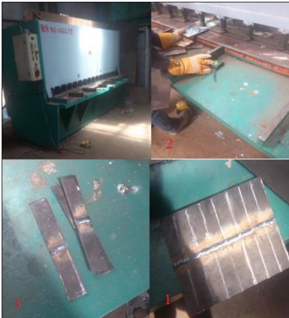
Figure 4.6 : étapes de découpage des éprouvettes.
