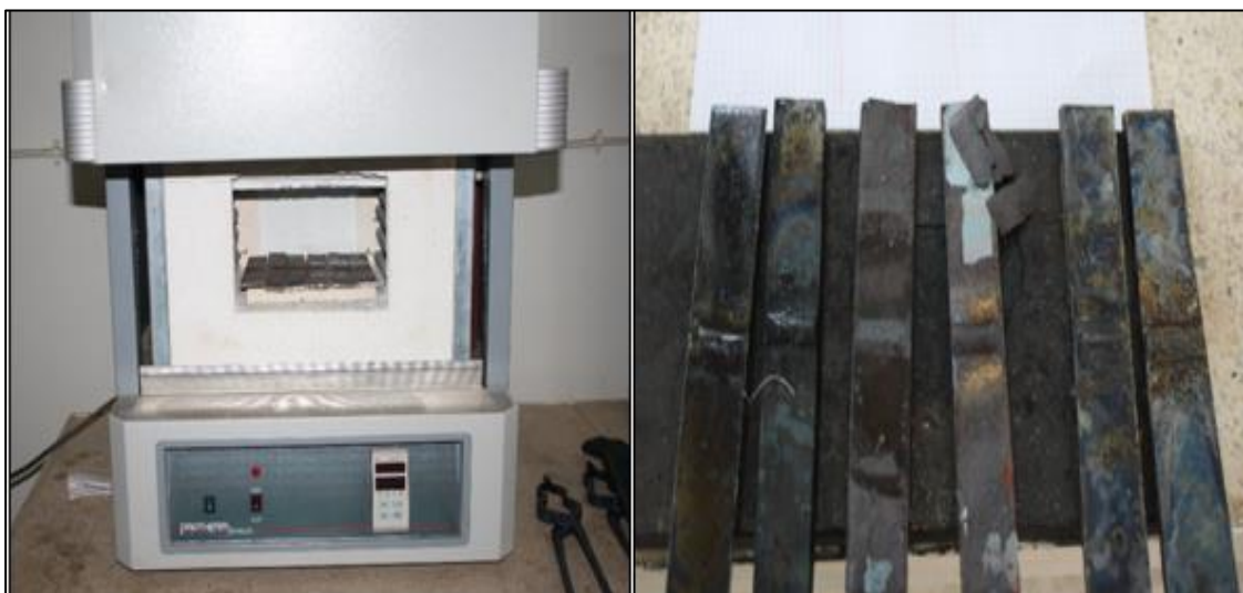
Figure 4.8 : traitements thermiques des éprouvettes dans un four a résistance.
