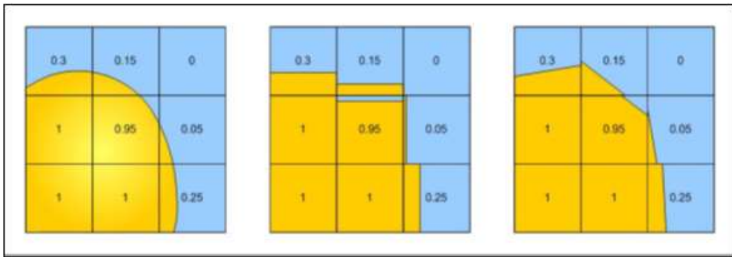
Fig.3.3 Différentes formes de l'interface pour le calcul vof ; (à gauche) Interface réelle et fonction couleur associée ; (au milieu) Classe de méthodes SLIC pour reconstruire l'interface ; (à droite) Classe de méthodes PLIC pour reconstruire l'interface.
