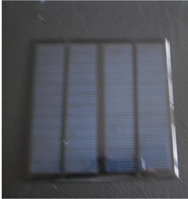
Fig. IV. 7 : Panneau photovoltaïque polycristallin.
