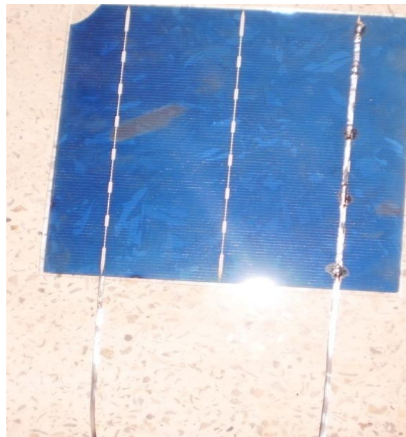
Fig. IV. 2: Soudage des fils (positive et négative) sur la cellule photovoltaïque polycristallin.
