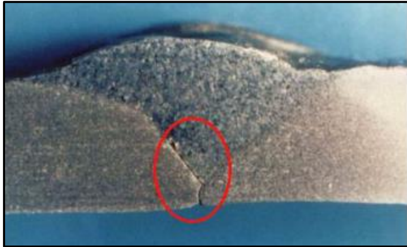
Figure III.13 : Manque de pénétration et collage en bord de chanfrein [49].
