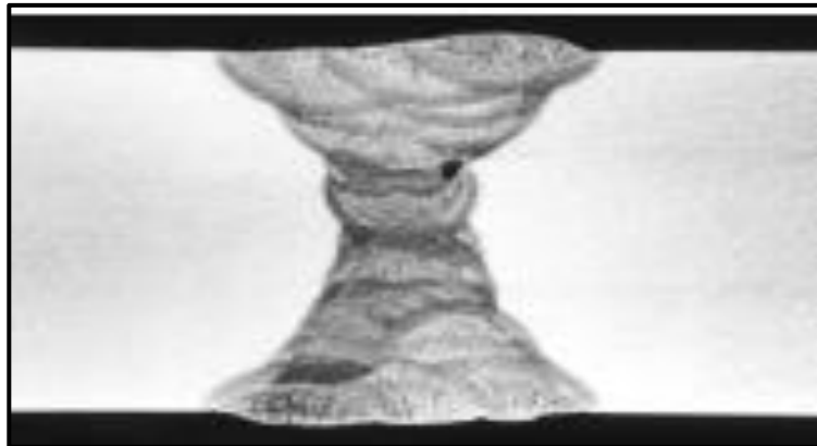
Figure III.21 : Inclusions de laitier.
