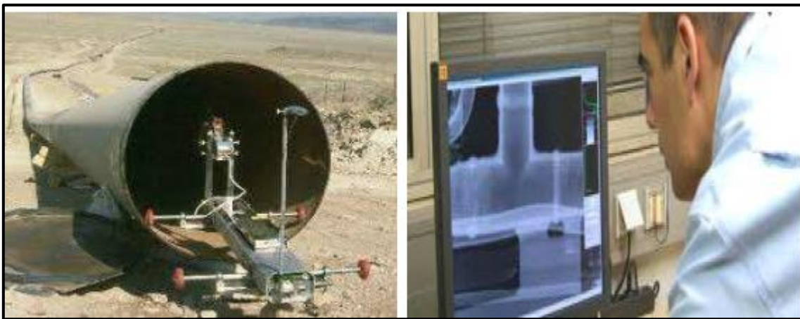
Figure III.43 : Principe de contrôle par radiographie [58].
