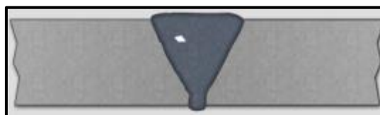
Figure III.23 : Inclusions de cuivre.
