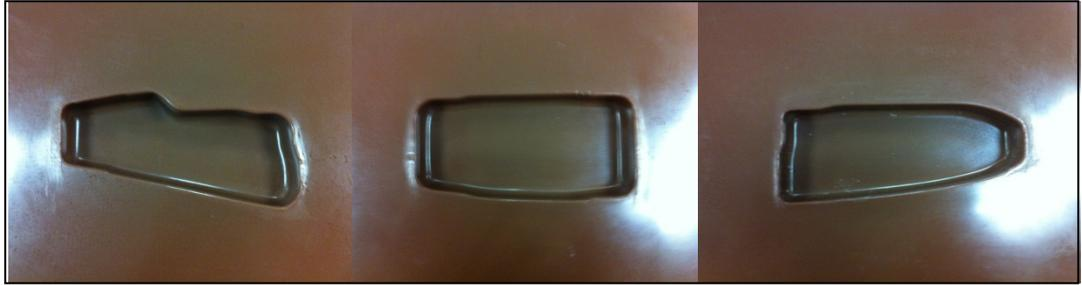
Figure 3.15 Agrandissement des zones de moulages des nervures
