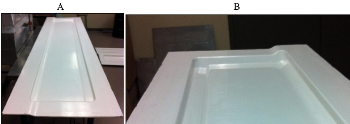
Figure 3.13 Moule pour la fabrication de l'extrados.
