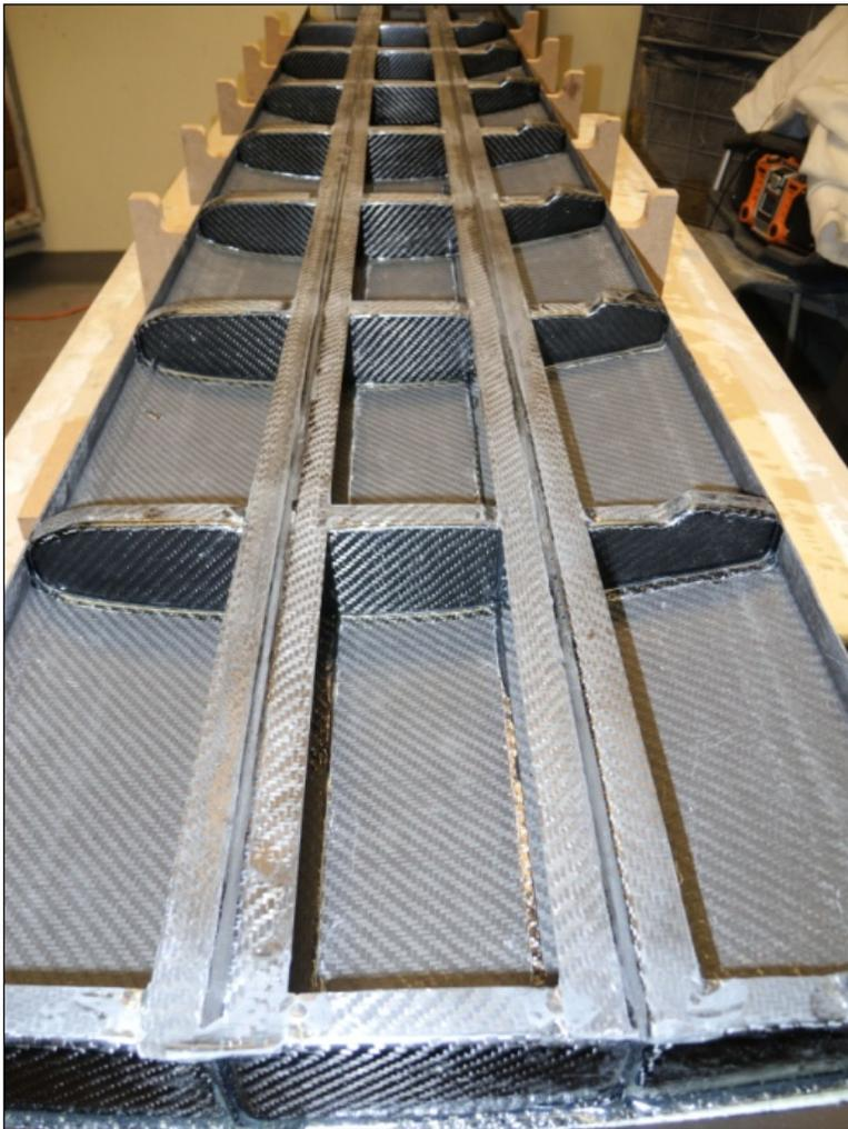
Figure 3.32 Ensemble de la structure interne de l'aile
