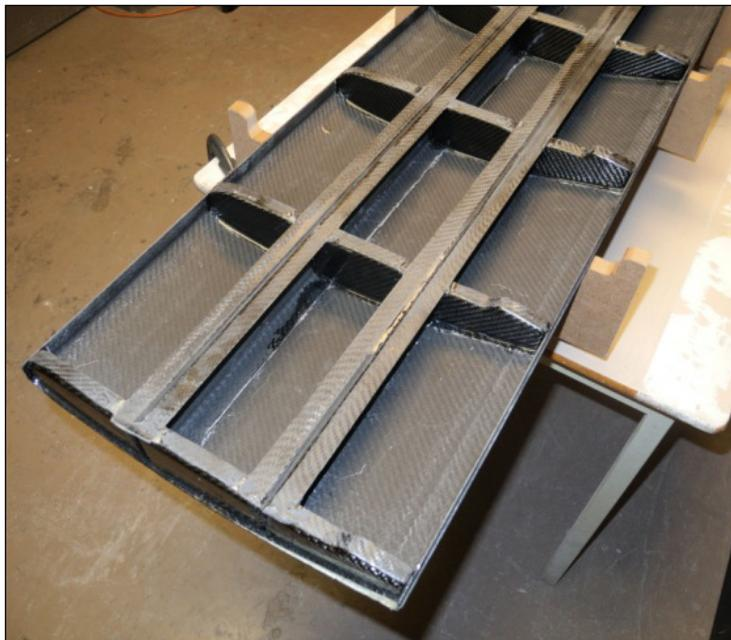
Figure 3.28 Extrémité de la structure interne de l'aile
