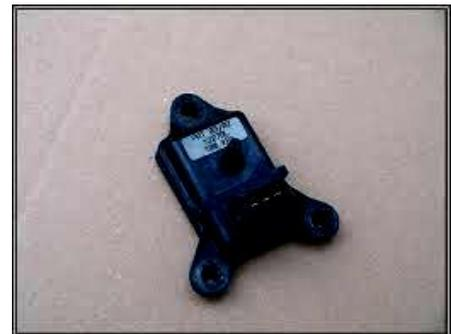
Figure 2.30. capteur de pression absolue
