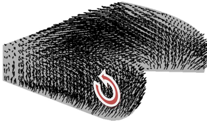
Figure .4. 14. Mouvements de tumble
