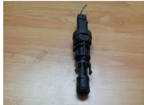
Figure 2.39. Capteur de vitesse du véhicule
