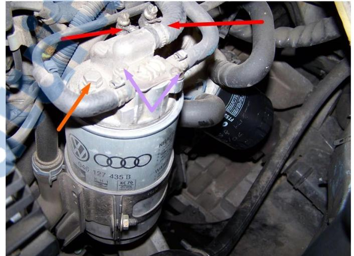
Figure 2.6. Filtre à carburant (Audi et VW)
