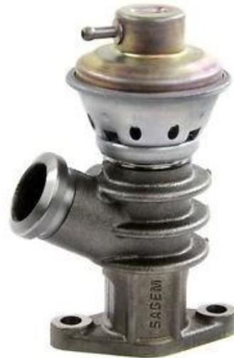
Figure 1.19. Schéma recirculation des gaz d'échappement    figure 1.20. la vanne EGR
