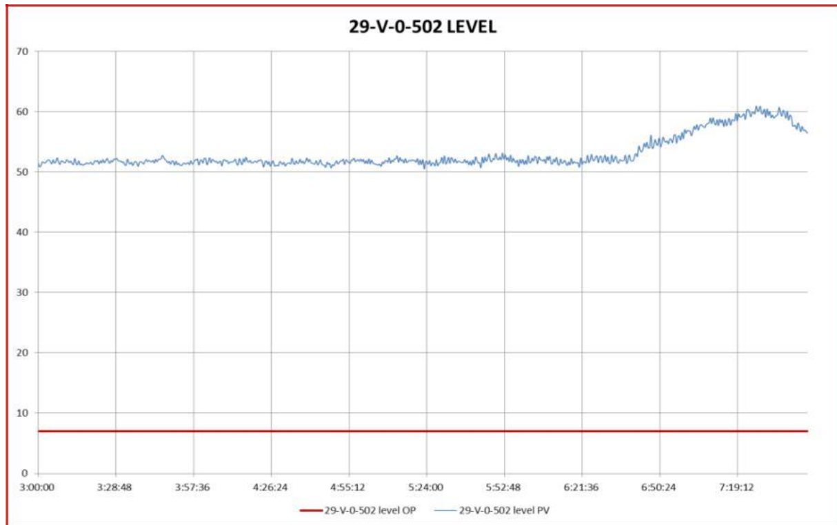
Figure V.4 : Le niveau dans le KO Drum de 5 ème étage train 1
