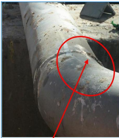
Photos V. 3 : Rupture de la soudure.
