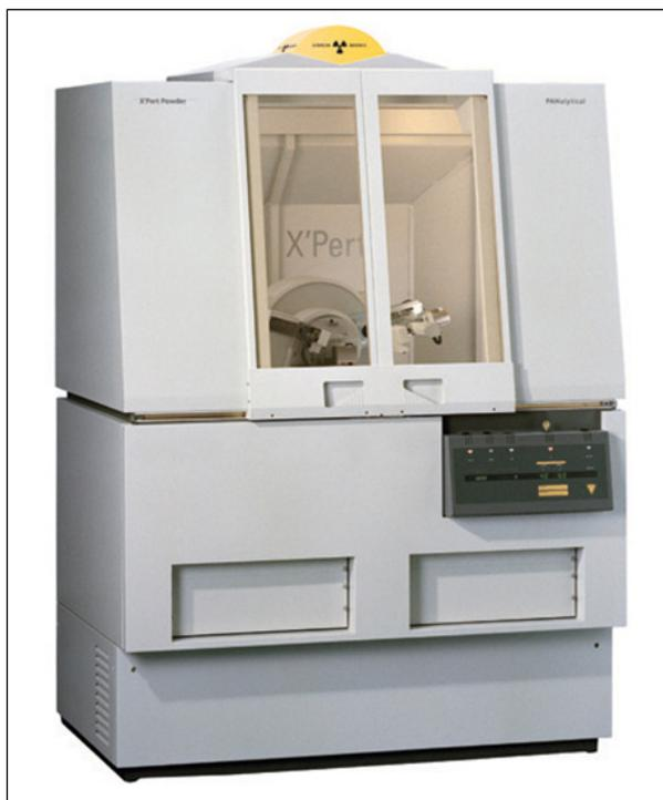
Figure 2.11 Diffractomètre à Rayons X X'Pert Pro de la compagnie PANalytical
