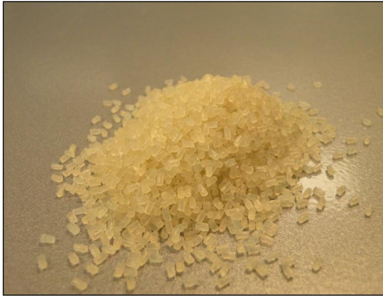
Figure 2.6 Pastilles de nano composites à la sortie du couteau rotatif
