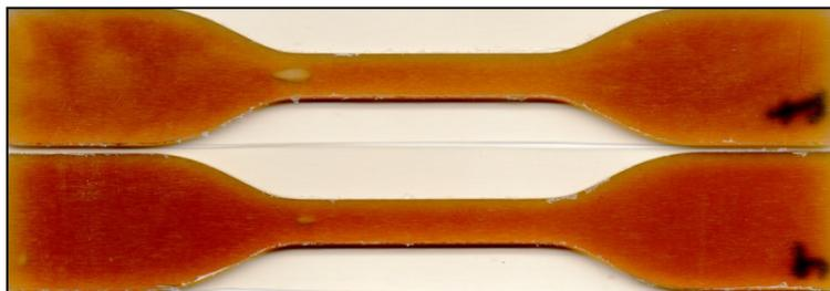
Figure 3.3 Visualisation de l'influence du nombre de passes au travers l'extrudeur sur les spécimens de traction
