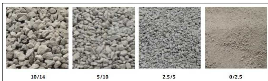
Figure 3.11 Séparation du MR5 en quatre classes granulométriques en vue d'une reconstitution
