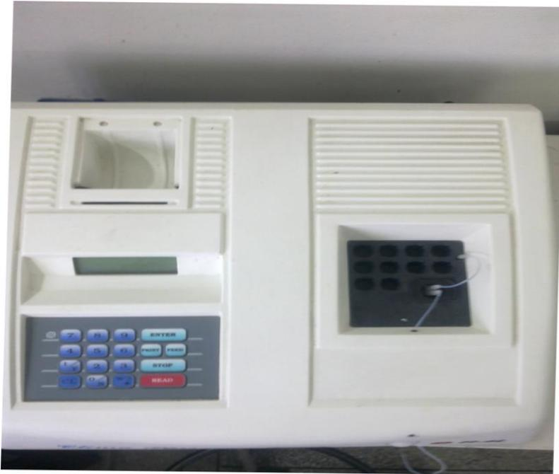
**Figure : 5 Spectrophotomètre climat plus**
