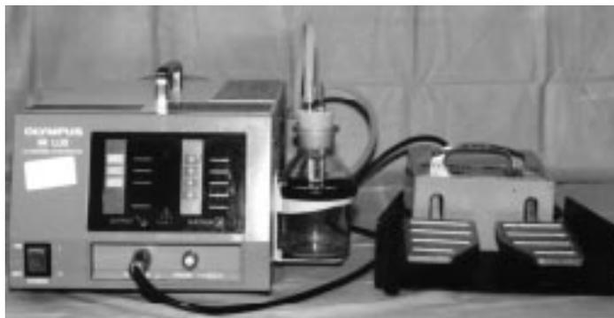
**Figure 23 : Lithotriporteur à ultrasons avec aspiration.**
