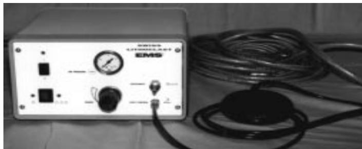
**Figure 22: Générateur d'un lithotriporteur à percussion mécanique fonctionnant à l'air comprimé.**
