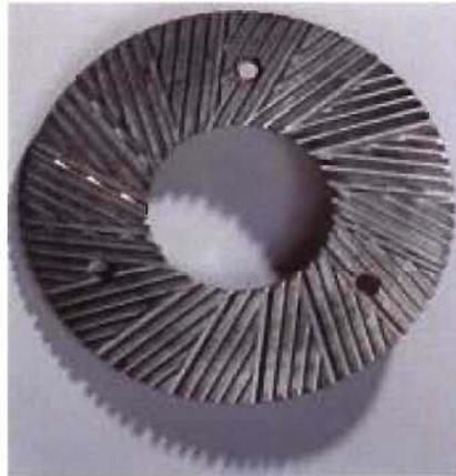
**Figure 1.2** Représentation d'un disque d'un raffineur à disques [6].
