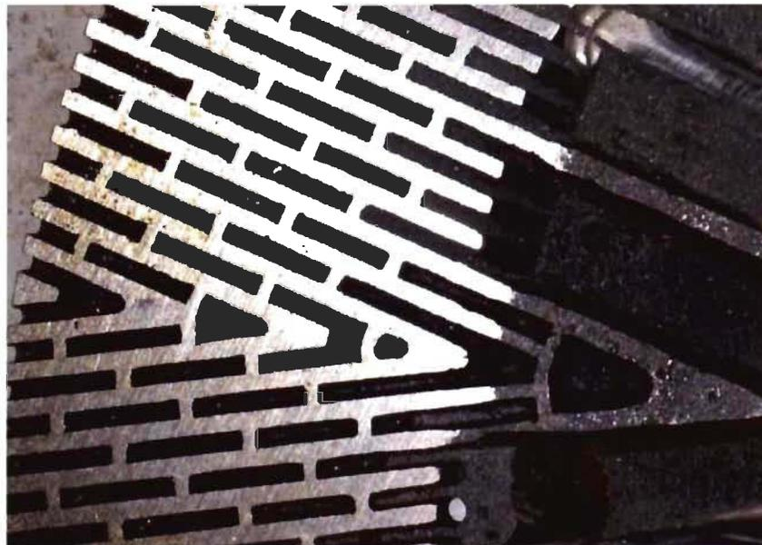
**Figure 7.15** Lames lisses d'un raffineur et absence de rugosité apparente sur ces lames.
