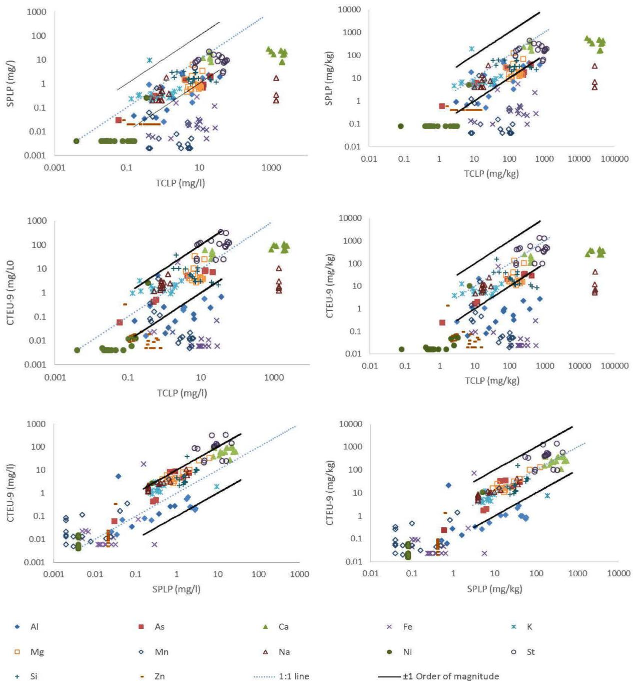
Figure 6-2 : Comparaisons des essais de lixiviation en batch réalisés sur les mélanges initiaux de minéraux purs
