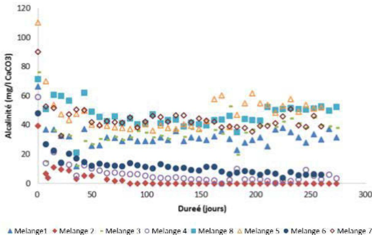
Figure 6-13 : Évolution de l'acidité des mélanges durant les essais en mini-cellule d'altération.
