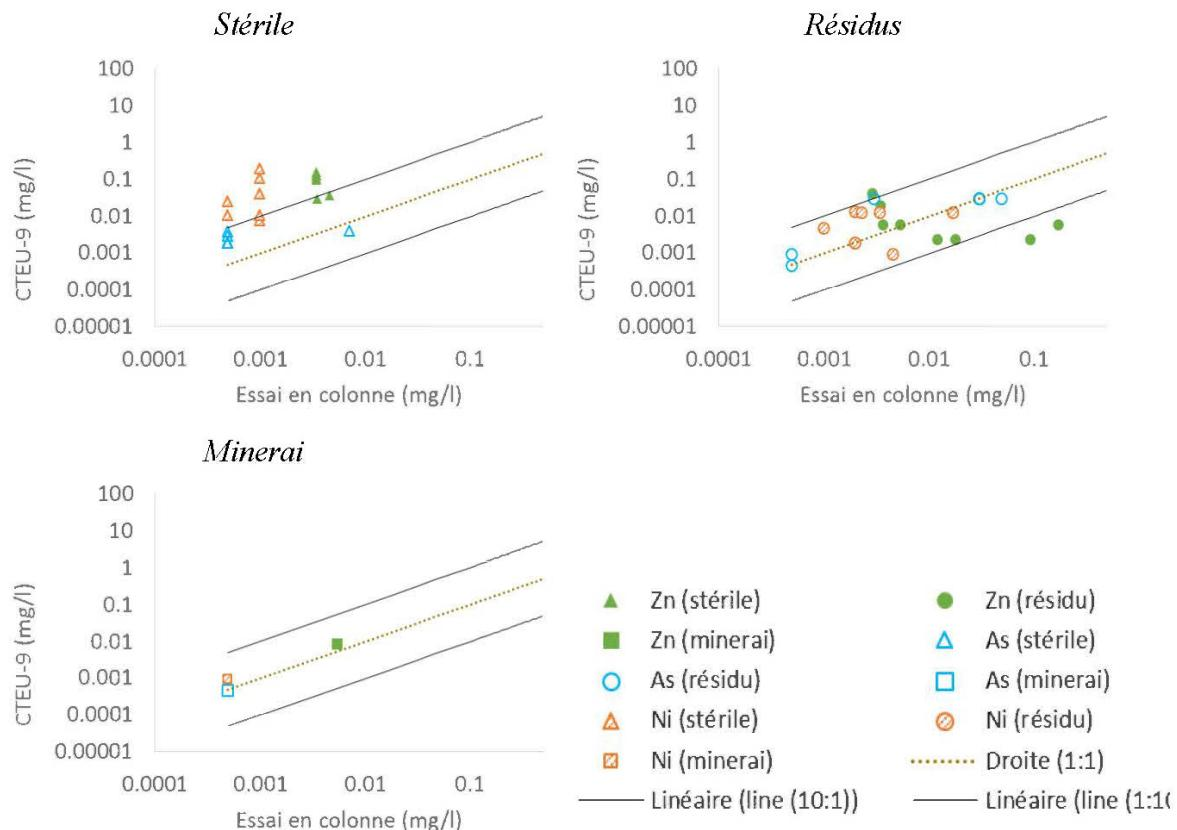
Figure 6-10 : Comparaison du CTEU-9 à l'essai en colonne par type d'échantillons (stérile, résidu ou mineraï)
