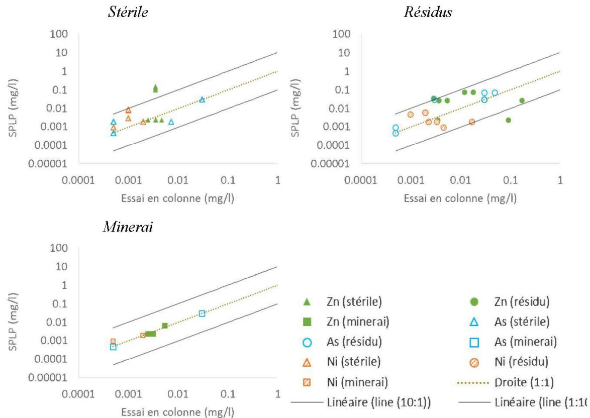
Figure 6-9 : Comparaison du SPLP à l'essai en colonne par type d'échantillons (stérile, résidu ou mineraï)
