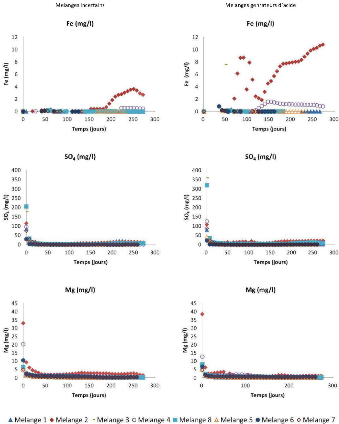
Figure A.3 : Évolution de la concentration de Fe, SO<sub>4</sub> et de Mg durant l'essai en mini-cellule d'altération
