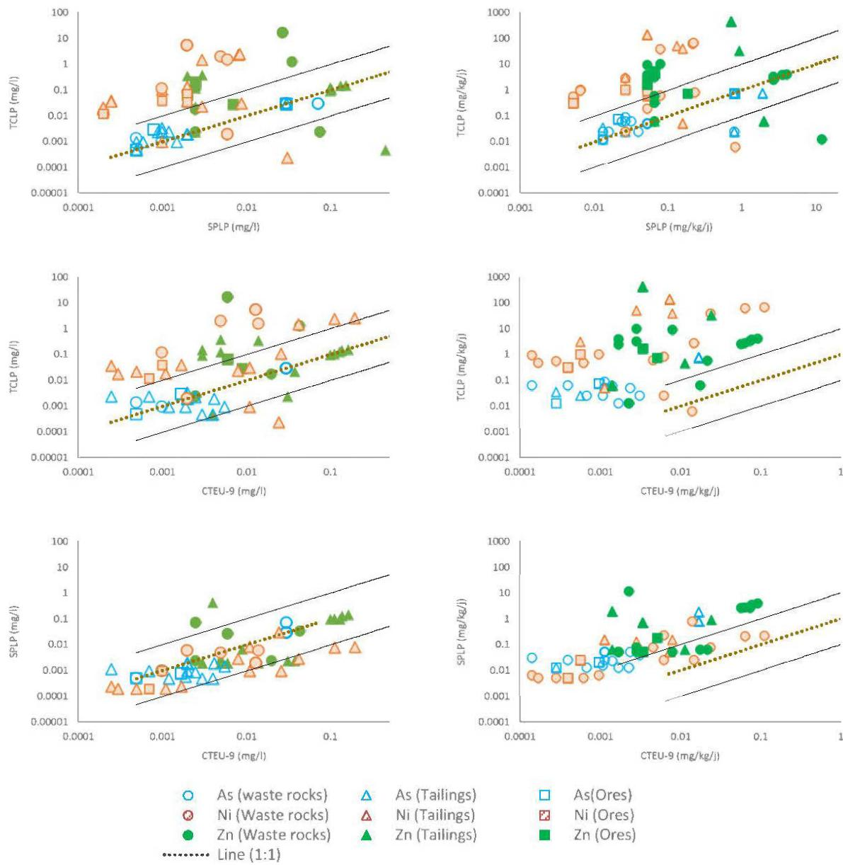
Figure 6-1 : Comparaison des essais de lixiviation en batch avec les concentrations (mg/l) et les taux journaliers (mg/kg/j)
