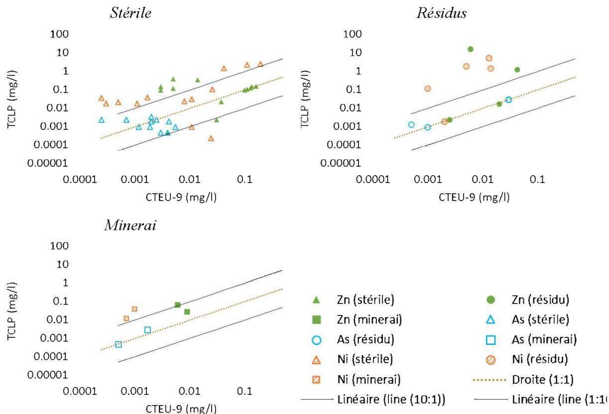
Figure 6-5 : Comparaison du TCLP au CTEU-9 par type d'échantillons (stérile, résidu ou mineraï)
