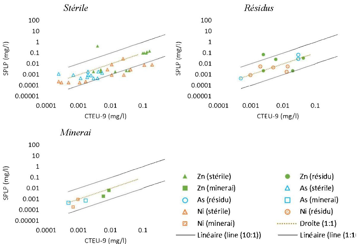
Figure 6-6 : Comparaison du SPLP au CTEU-9 par type d'échantillons (stérile, résidu ou minéral)
