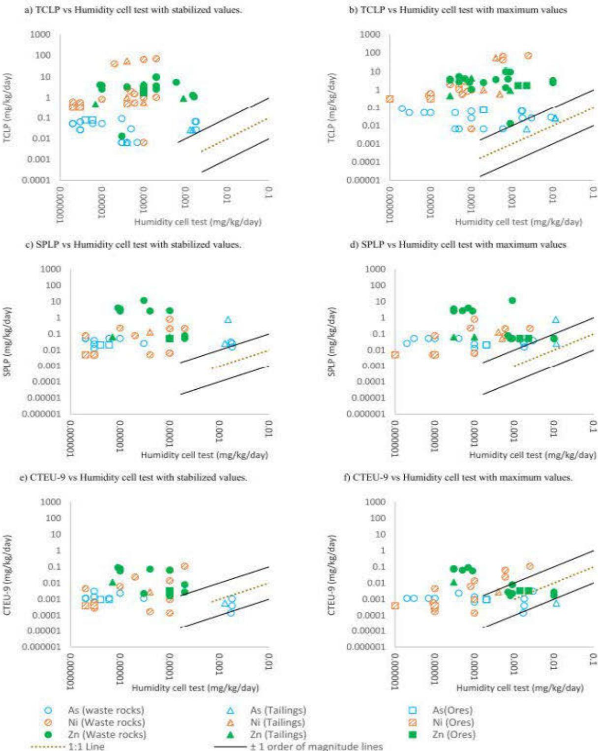
Figure 6-7 : Taux journaliers de l'essai en cellule humide comparés aux essais en batch
