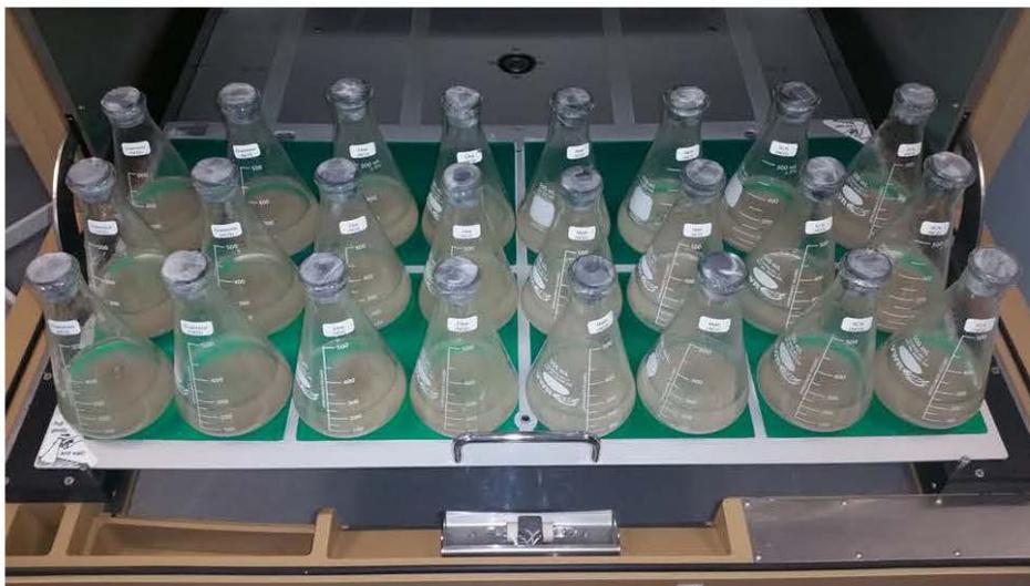
Figure A. 1: Montage des essais en Batch
