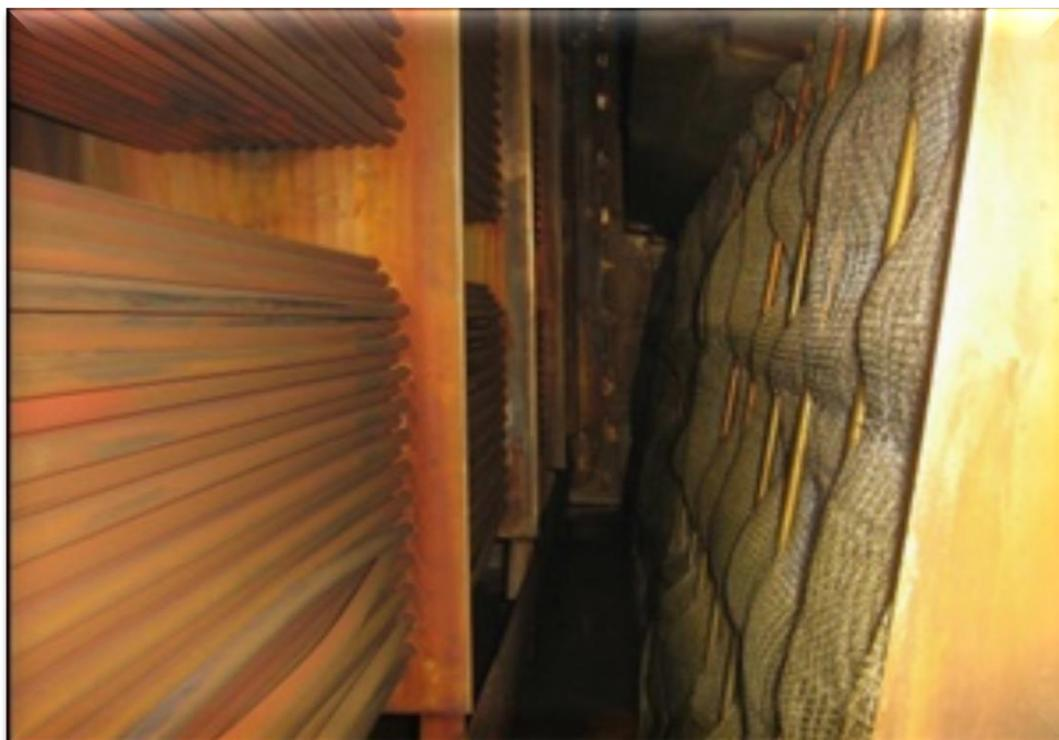
Figure III.16: 4<sup>ème</sup> cellule (séparateur, faisceau tubulaire du condenseur distillateur).
