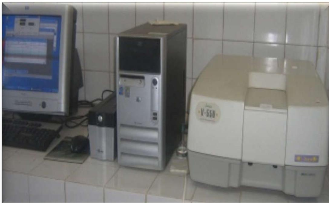
Figure IV.35 : Spectrophotomètre type JASCO V-550
