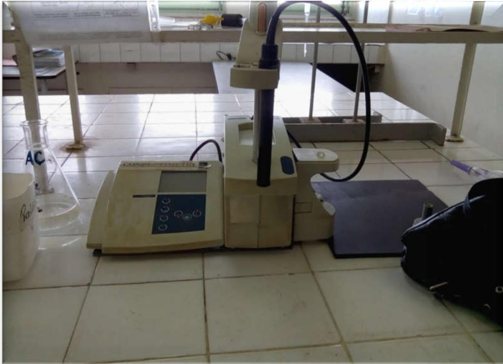
**Figure IV.38:** appareil de Conductimètre de type INOLAB Condlevel 1.
