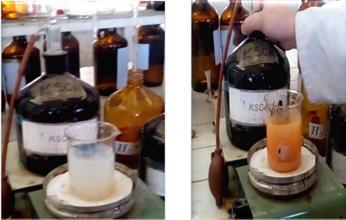
Figure IV.45: Dosage des chlorures ( $\text{Cl}^-$ ) dans l'eau
