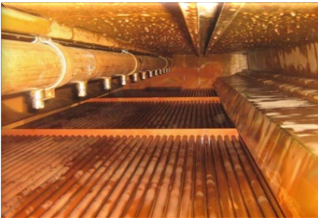
Figure III.15: 3<sup>ème</sup> cellule (rampe d'arrosage, faisceau de chauffe).
