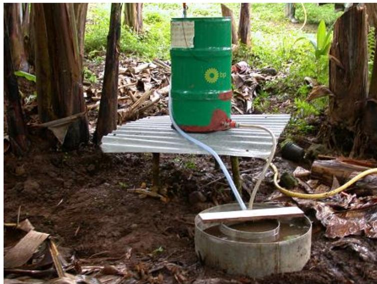
**Photo 5** : Illustration de la mise à saturation, 24h avant la réalisation de la mesure (Source : A.Cavasino, 2005).
