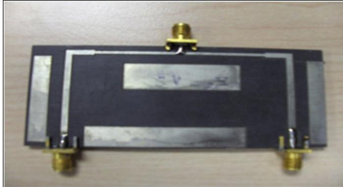
**Figure 2.24 Combineur Chireix sans stub fabriqué.**
