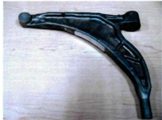
Figure 4.2 : Bras de suspension inférieur.
