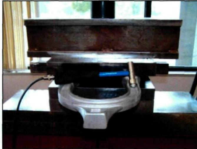
Figure 4.16 : Expérience des fréquences par marteau d'impact.
