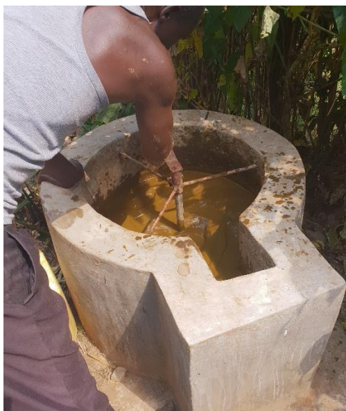
Fig. 6 : le substrat est mixé avec l'eau, formant un mélange homogène, d'où les composants non-fermentescibles sont retirés manuellement. Photo prise le 29.06 dans la propriété de Simon NTAGAHINDA.
