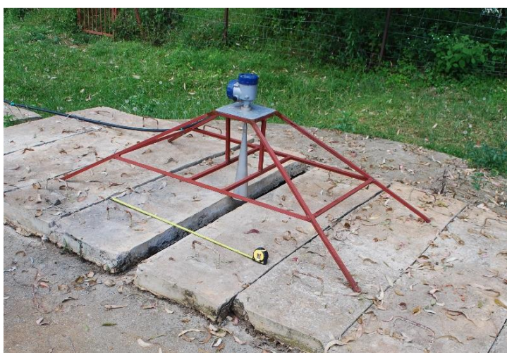
Fig. 10: mesure de la composition du gaz sur les chambres d'évacuation du digesteur de l'IPRC-Tumba. Photo prise le 15.06 sur le site de l'école.
