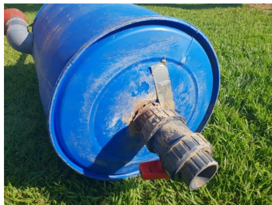
Fig. 23: partie inférieure du prototype de digesteur de 200L, et conduite d'évacuation du digestat et robinet (en rouge). Des dégâts ont été constatés au niveau de la jonction entre le bidon et le robinet.
