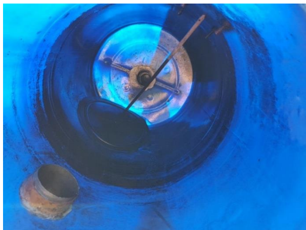
Fig. 22: intérieur de la chambre de digestion du prototype de 200L, avec l'entrée du substrat (en bas à gauche), l'agitateur manuel (centre) et la sortie de gaz (arrière-plan, au centre).
