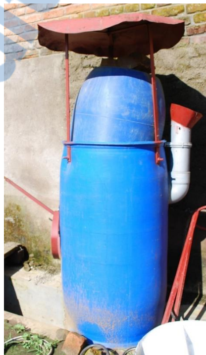
Fig. 20: prototype de digesteur de 200L réalisé par Jose Hoyoz dans le cadre de son travail de diplôme en 2016 et laissé en l'état sur le site de l'IPRC-Karongi.
