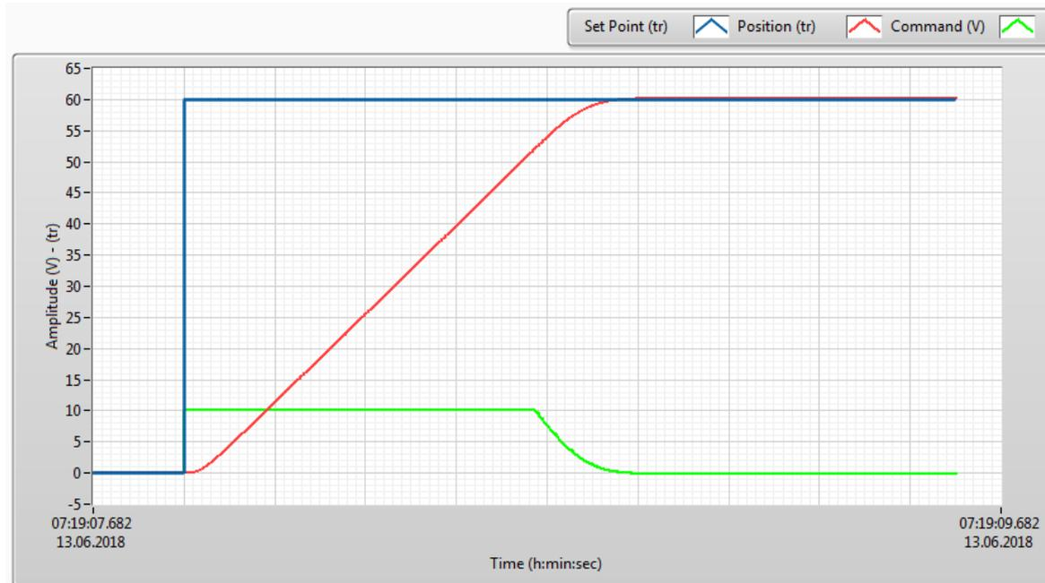
FIGURE 7.27 – Régulation P du moteur en position avec codeur (LabVIEW)
