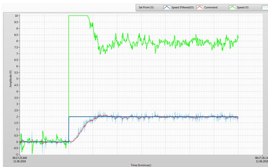
FIGURE 7.10 – Mesure régulation de vitesse Feed-Forward (LabVIEW)
