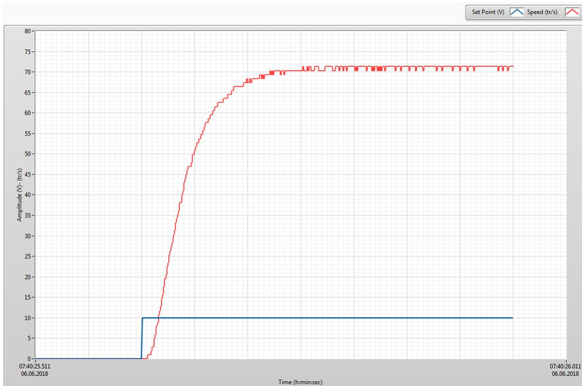
FIGURE 7.11 – Mesure réponse vitesse saut indiciel
