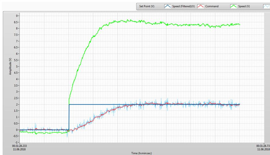
FIGURE 7.9 – Mesure régulation de vitesse PI (LabVIEW)
