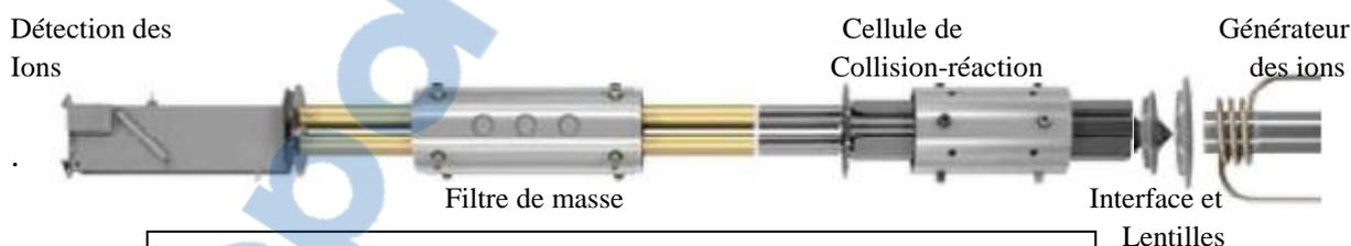
**Figure 8 : ICP-MS quadripolaire avec cellule collision-réaction**
