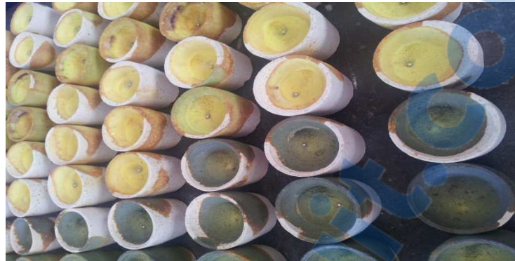
Figure 11: Images des boutons d'Argent après coupellation
