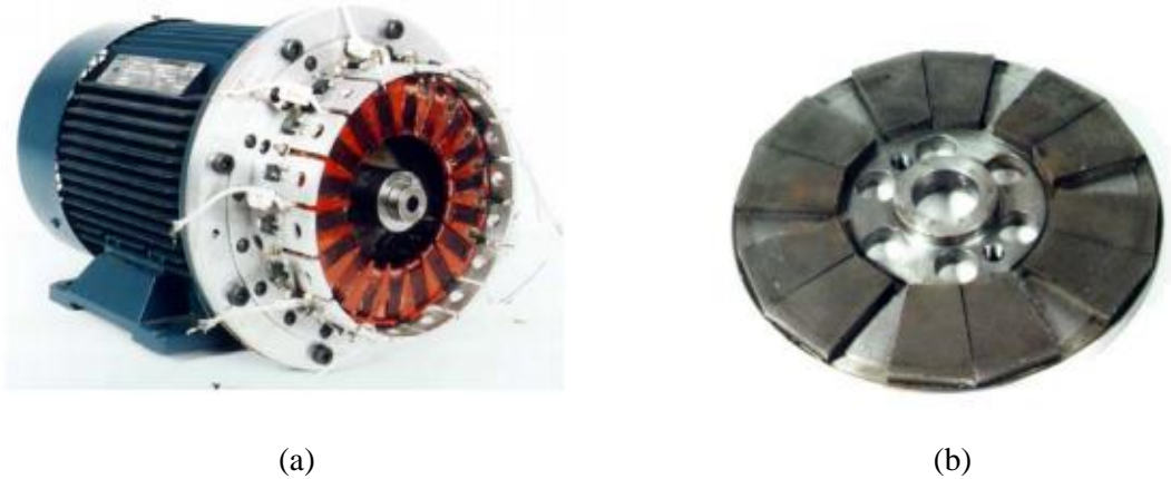
Figure II.15. TORUS à bobinage toroïdal : (a) prototype de la machine (stator visible à 18 bobines) montée sur le moteur d'essai et (b) rotor de la machine (6 pôles) [34].
