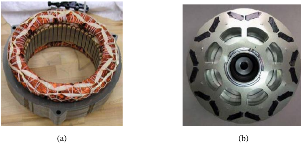
Figure II.9. Toyota Prius 2010 : (a) stator à bobinage distribué et (b) rotor à APs enterrés en « V » [24].
