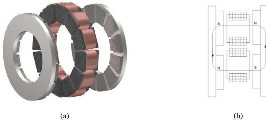
Figure II.20. TORUS avec stator segmenté (YASA) : (a) vue de la machine et (b) chemin du flux [38].
