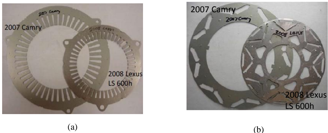
Figure II.8. Toyota Camry et Lexus LS 600h : (a) stators à bobinage distribué et (b) rotors [24].
