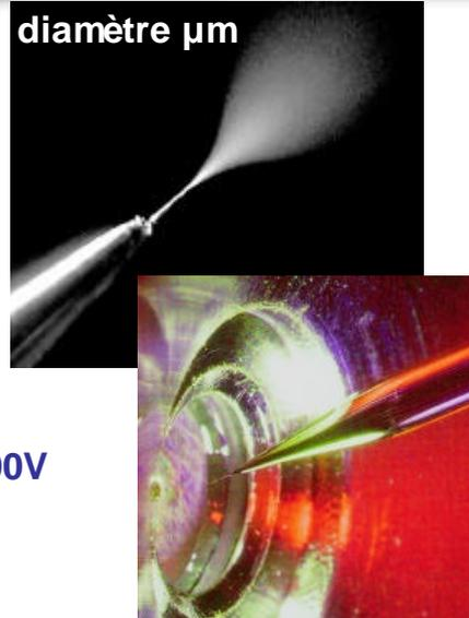
Dans le cas de spectromètre de masse dont la source est une source électrospray. L'échantillon qui contient les peptides est injecté grâce à une aiguille en verre recouverte d'or et de palladium et soumise à un très haut voltage.
