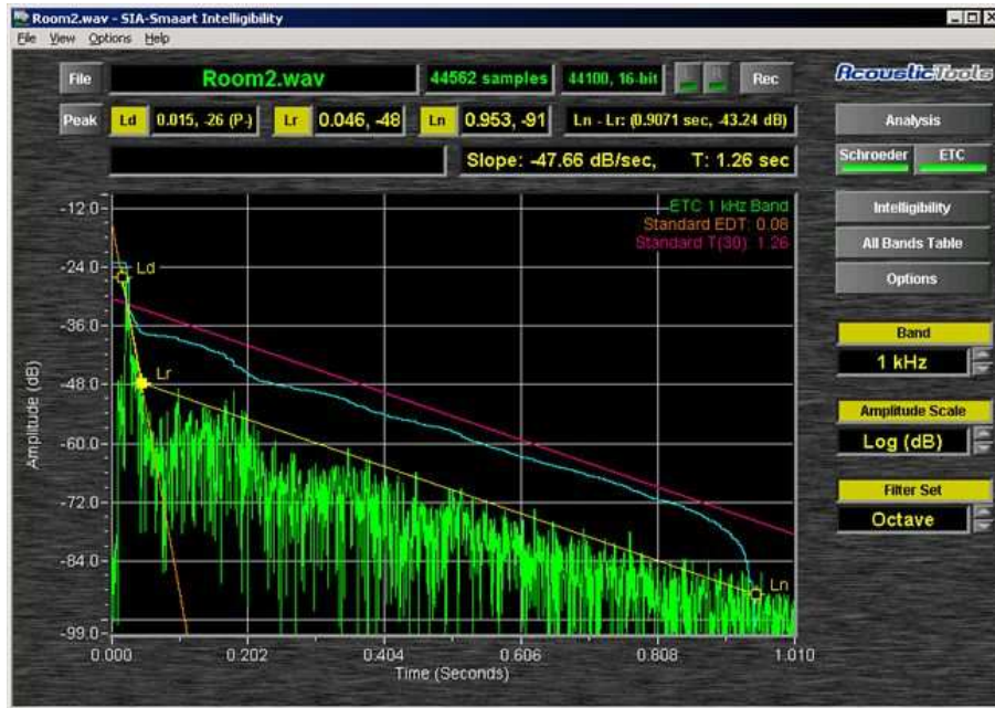
FIG. 13.7 – Mesure du temps de réverbération.
