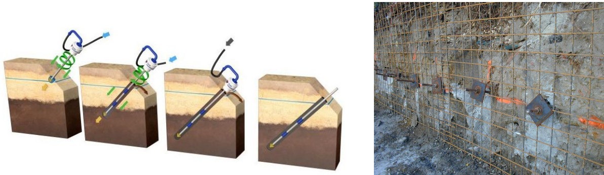
FIGURE 2.9 – A gauche, réalisation d'un clou à l'aide d'une barre autoforante : la barre d'ancrage est utilisée comme barre de forage équipée à son extrémité d'un taillant perdu, la barre est constituée d'un tube en acier à travers duquel est injecté après forage le coulis de scellement. A droite, têtes de clous équipées de plaques de répartition avant bétonnage (par béton projeté) de la paroi clouée (source : atlas-fondations.fr)
