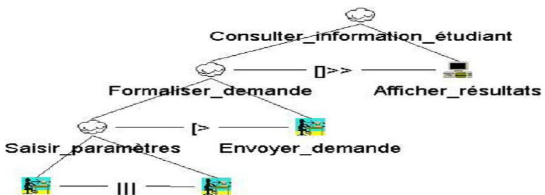
Fig. 3.5 La modélisation CTT d'une tâche de consultation des informations concernant un étudiant (adoption d'un exemple fourni avec l'environnement CTTE) [4].
