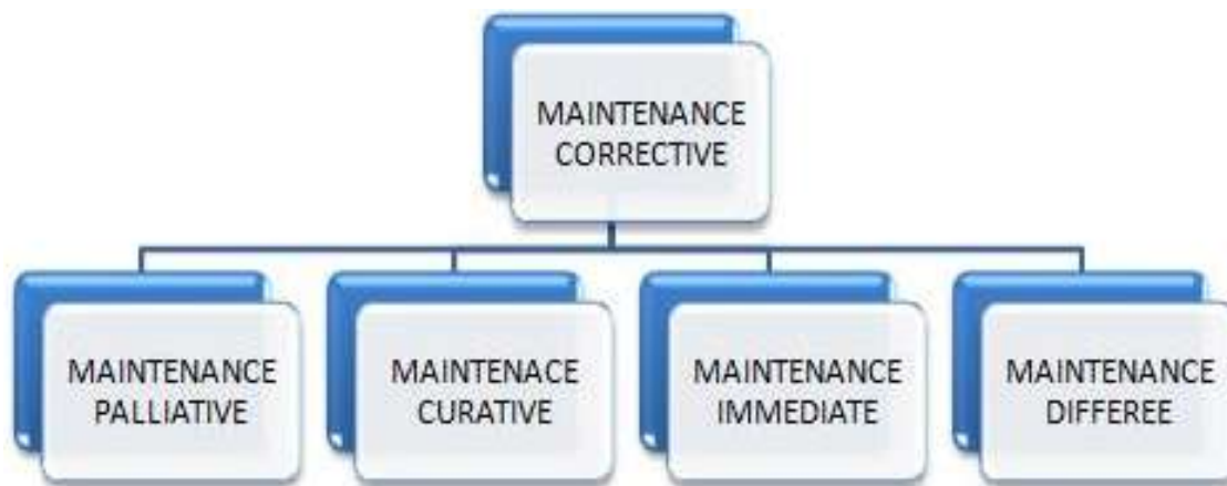
Typologie de la maintenance corrective
