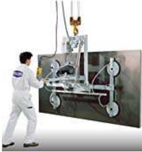
Figure 1.73: Un système de levage par ventouses.
