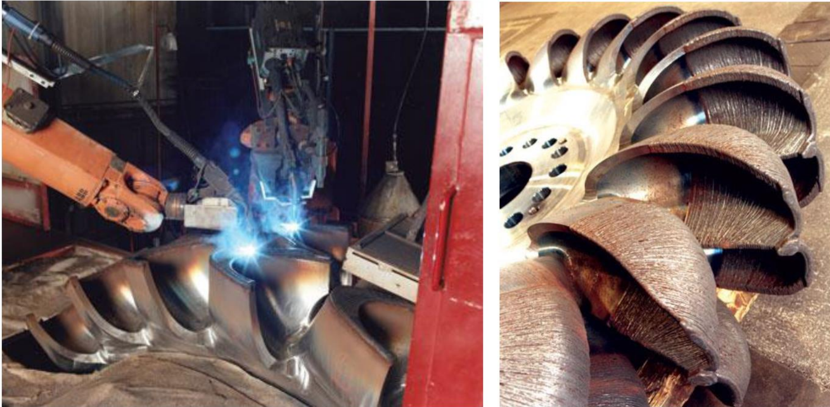
Ajout de matière sur un disque central forgé [Appelyard 2012]
