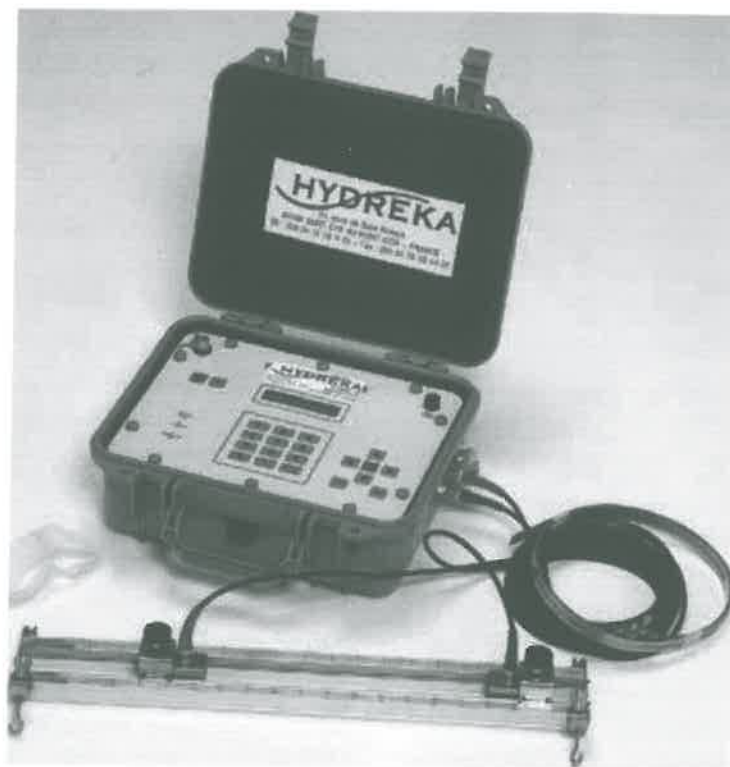
Figure 14 : Le débitmètre ultrason DCT 7088
