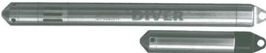
Figure 11 : Sondes piézométriques CTD-DIVER et BARO-DIVER
