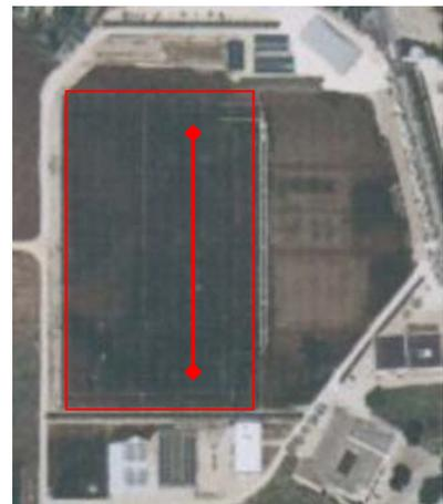
Une bande roulement sera étudiée, traversant la parcelle selon l'axe nord/sud. L'orientation de cette bande permet d'offrir des conditions hydriques plus variées qui peuvent potentiellement permettre d'observer des variations de tassement. Cette bande sera effectuée entre les deux rangées des sondes à neutrons afin de pouvoir profiter des relevés fournis par cette installation.
