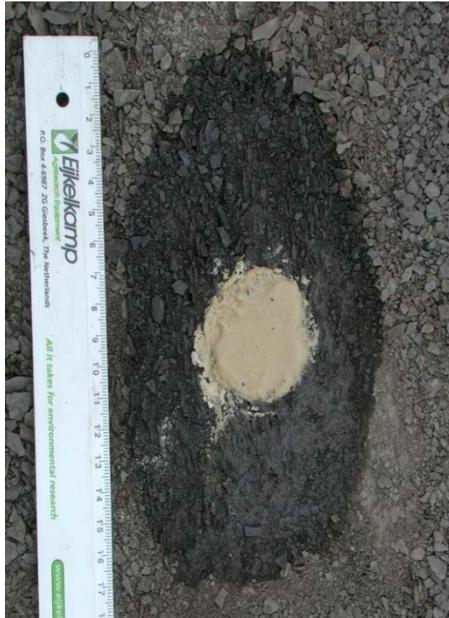
Figure 13 : photographie représentant la diffusion de l'eau en surface lors d'un essai d'infiltrométrie.
