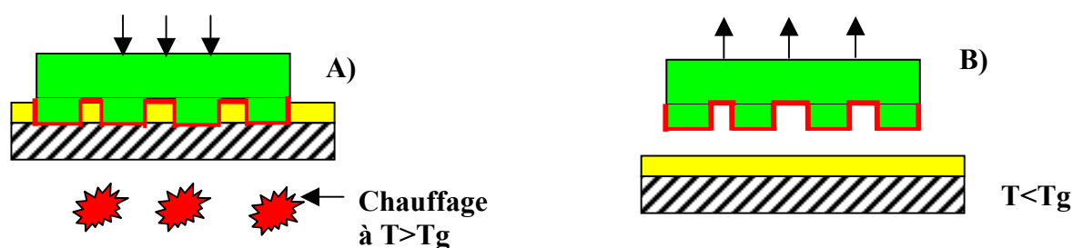
Figure 1 : Schéma de principe de l'impression à chaud ; A : phase d'impression ; B : phase de démoulage
