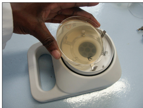
Figure 2 : Descriptif de l'Air Test Oméga ou Air Strategie Bio-Impactor
