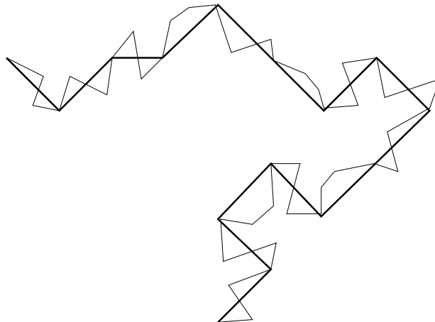
FIGURE 2.3 – Chaîne polymère vue à deux échelles différentes avec N' = N/3
