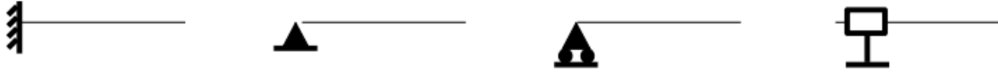
Figure 3.1: La symbolique des liaisons 2d utilisée dans ce cours (non normalisée) de gauche à droite : encastrement 2d, appui simple 2d, appui sur rouleau 2d, glissière 2d
