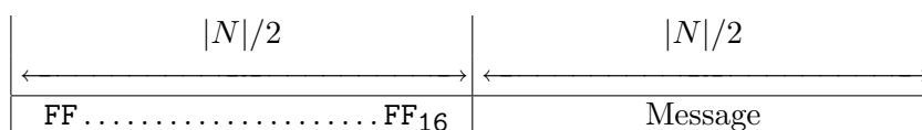
FIG. A.2 – Exemple de padding RSA falsifiable par la méthode de MARC GIRAULT et JEAN-FRANÇOIS MISARSKY où \omega = 1 et a = \text{FF} \dots \text{FF} \text{00} \dots \text{00}_{16}
