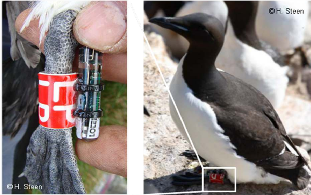
Fig. 2.5 Exemple d'un enregistreur TDR de pression et température (LTD 2400; Lotek Wireless, St. Johns, NF, Canada) attaché sur la bague d'un guillemot de Brünnich. © Harald Steen
