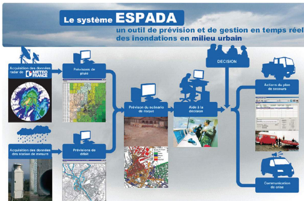
Source : Raymond et al. (2007) Figure 2.9 : Schéma fonctionnel du système ESPADA.
